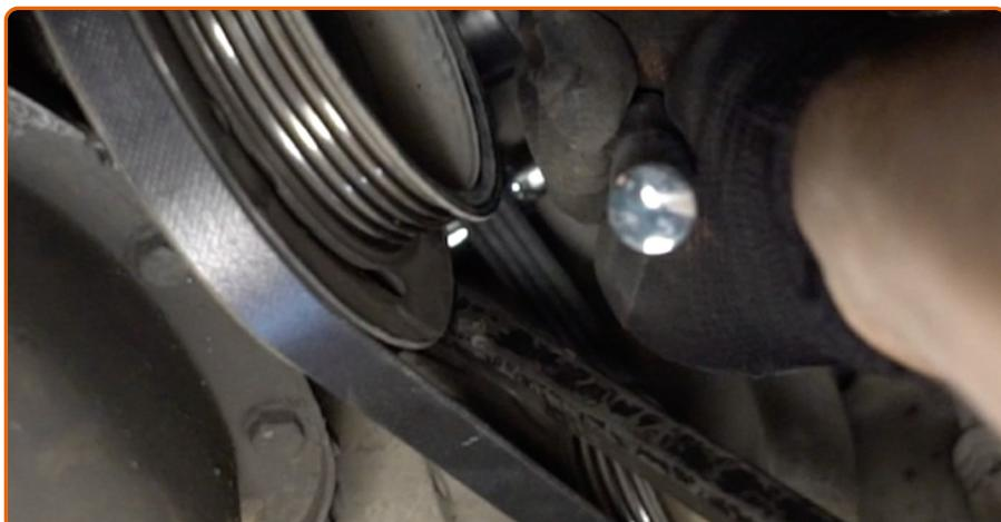
Aparafuse o elemento fixador superior do alternador. Use uma chave soquete nº 13. Use uma chave soquete nº 16. Use uma chave de catraca.
