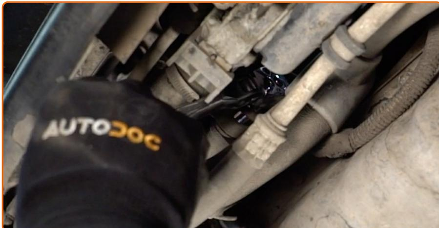
Aparafuse o elemento fixador inferior do alternador. Use uma chave soquete nº 13. Use uma chave soquete nº 16. Use uma chave de catraca.
