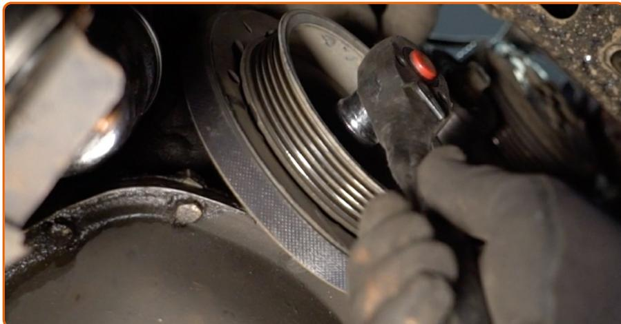
Coloque a correia serpentina na polia do eixo de manivela. Use uma chave soquete nº 18. Use uma chave de catraca.
