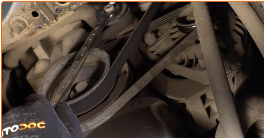
Solte os fixadores da polia tensora da correia do compressor do ar condicionado. Use uma chave combinada nº 21. Use HEX n.º H7.
