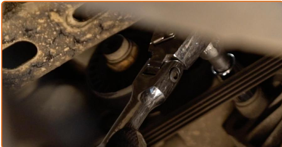
Solte o elemento fixador superior do alternador. Use uma chave soquete nº 13. Use uma chave soquete nº 16. Use uma chave de catraca.
