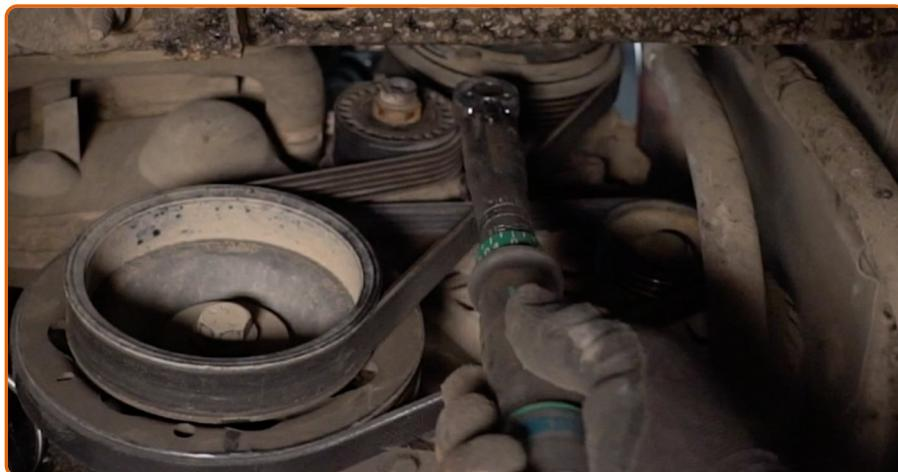
Aparafuse os fixadores da polia tensora da correia do compressor do ar condicionado. Use uma chave combinada nº 21. Use HEX n.º H7.
