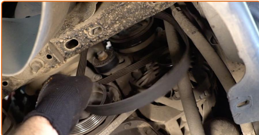
Remova a correia do compressor do ar condicionado.
