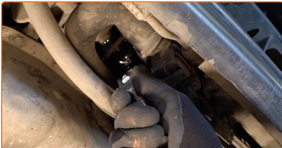
Solte o elemento fixador inferior do alternador. Use uma chave soquete nº 13. Use uma chave soquete nº 16. Use uma chave de catraca.
