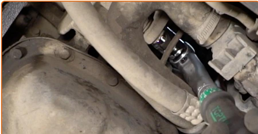
Aperte o elemento fixador superior do alternador. Use uma chave soquete nº 13. Use uma chave soquete nº 16. Use uma chave de torque. Aperte-o para o torque de 20 Nm.
