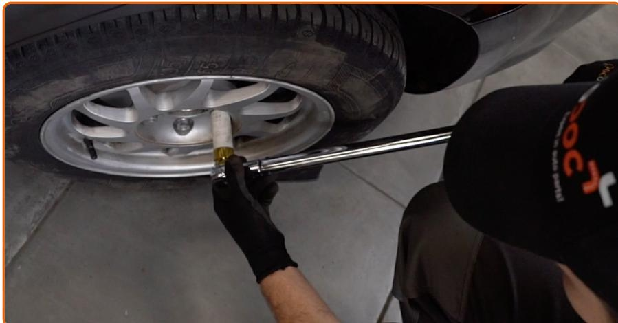
Baixar o carro e trabalhar em ordem transversal, apertar os parafusos das rodas. Use uma chave de torque. Aperte-o para o torque de 110 Nm.
