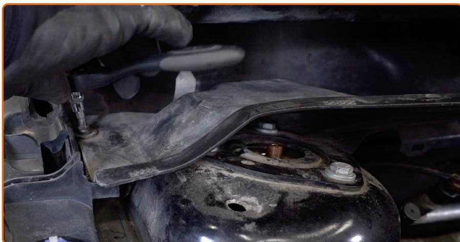
Limpe o local de montagem da grelha do capô. Use spray WD-40.
