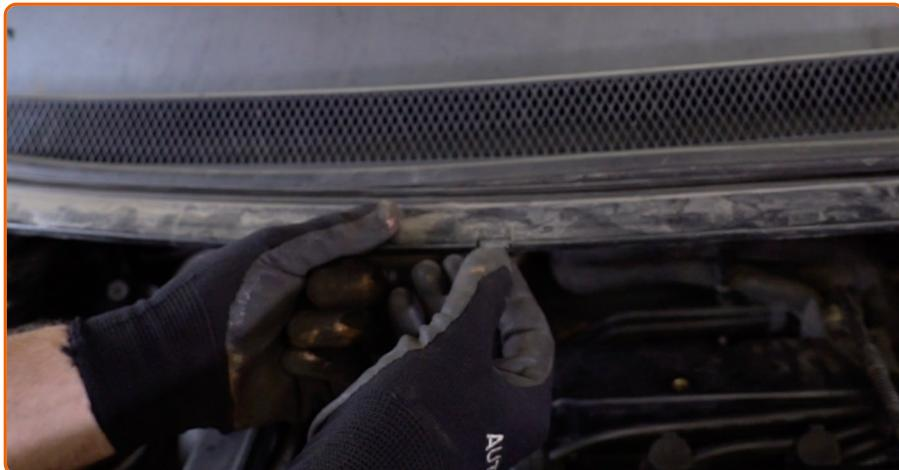
Instale e fixe a grelha do capô. Use Torx T30. Use uma chave de catraca.
