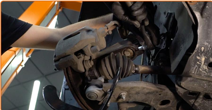
Solte o fixador inferior que conecta a coluna de suspensão às mangas de eixo. Use uma chave especial para remover o amortecedor. Use um martelo. Use um cinzel plano para metal.
