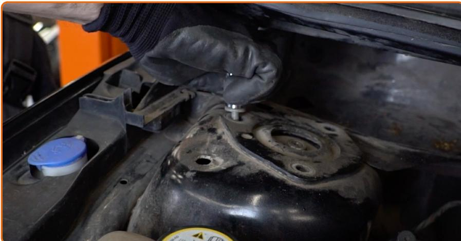
Desaperte a fixação do suporte superior do braço do amortecedor.
