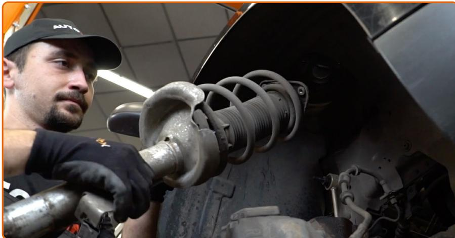
Remova o suporte de suspensão. Coloque o suporte do amortecedor sobre a ferramenta de compressão da mola.
