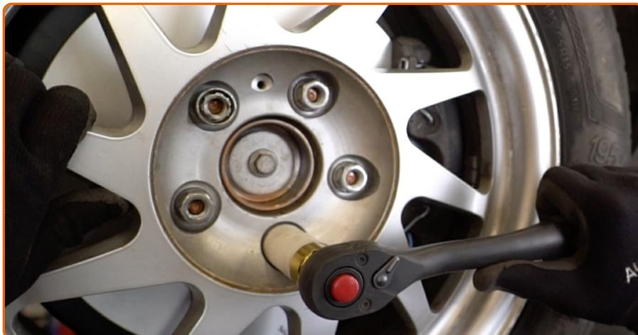
Aperte os parafusos da roda. Use o soquete de impacto para roda #19.
