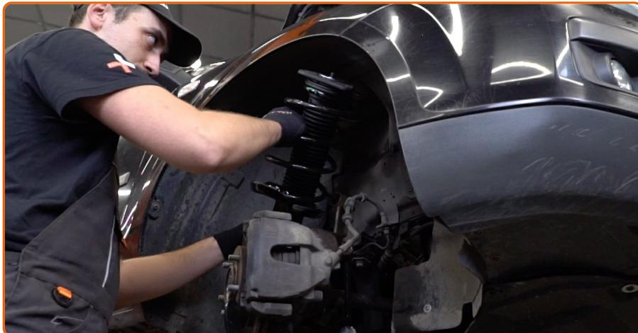
Instale o amortecedor no arco da roda.
