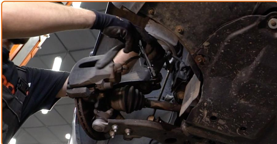
Desaparafuse o elemento de fixação inferior que liga a coluna de suspensão às mangas de eixo. Use uma chave soquete nº 18. Use uma chave de catraca. Use uma chave de tarrraxa.
