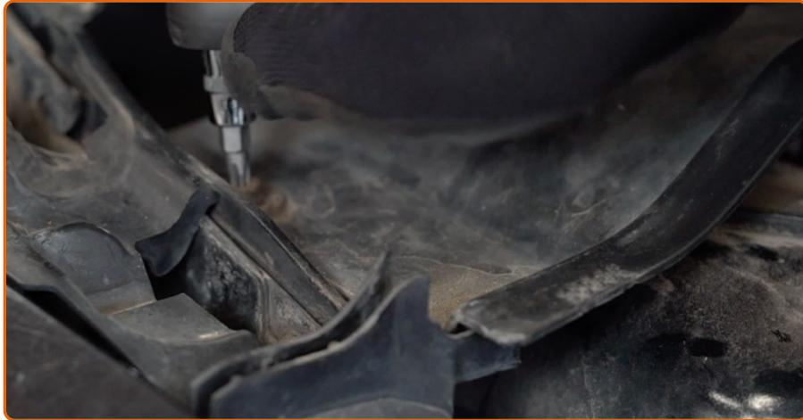
Desaparafuse o fixador da carenagem da grelha de plástico do limpa para-brisas inferior. Use Torx T30. Use uma chave de catraca.
