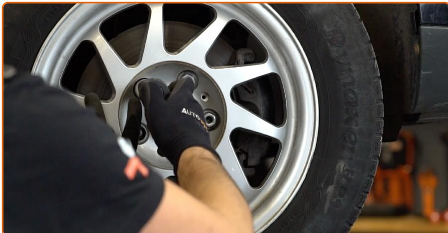
Desaperte os parafusos da roda.
