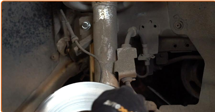
Desligue a instalação elétrica e a mangueira do travão do braço de suporte do amortecedor.
