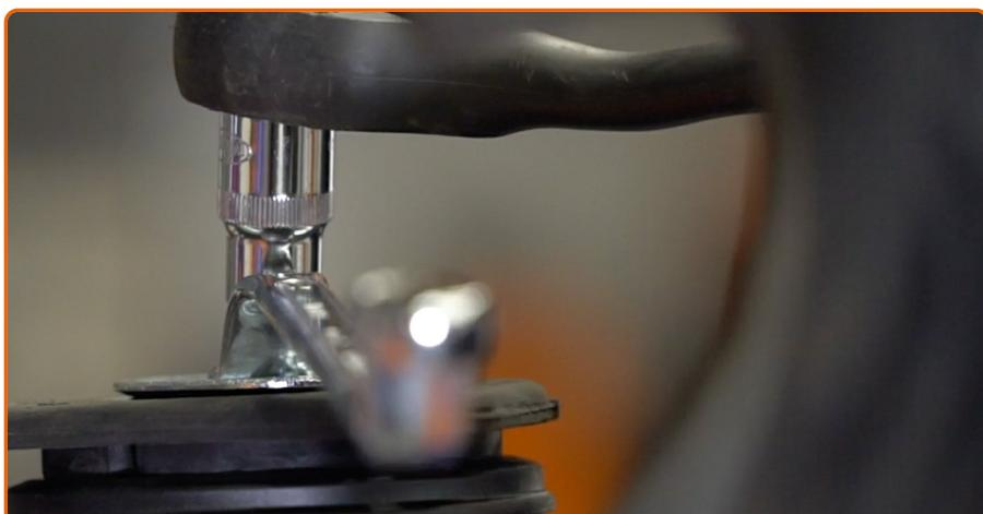
Aperte a porca do suporte do amortecedor da haste do pistão. Use Torx T30. Use uma chave combinada nº 19. Use uma chave de torque. Aperte-o para o torque de 55 Nm.
