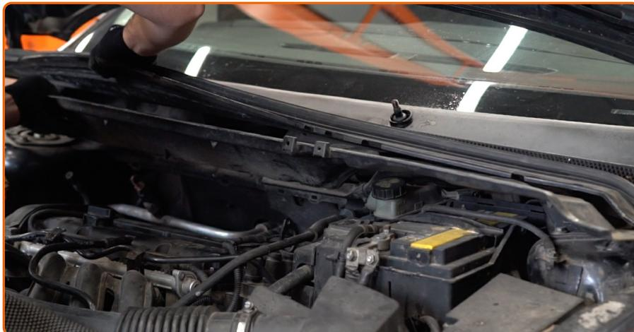
Remova a carenagem da grelha de plástico do limpa para-brisas inferior.
