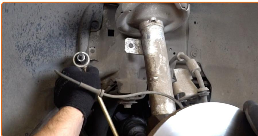
Desaperte a porca e remova a barra estabilizadora do amortecedor. Use uma chave soquete nº 15. Use uma chave de catraca.
