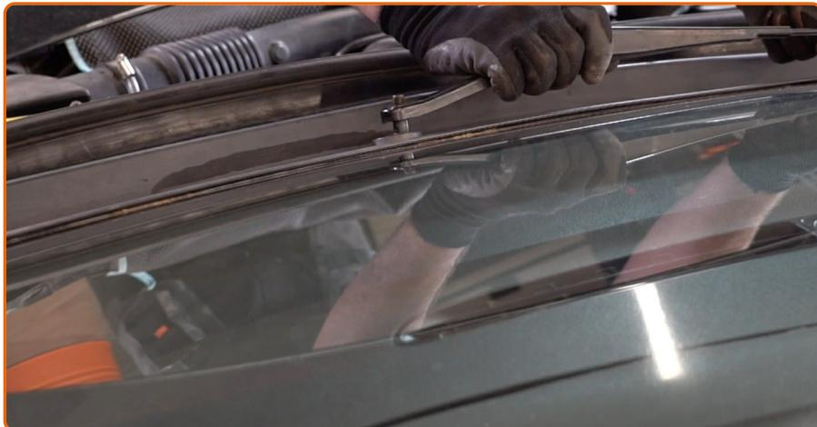
Instale os fixadores da carenagem da grelha de plástico do limpa para-brisas.
