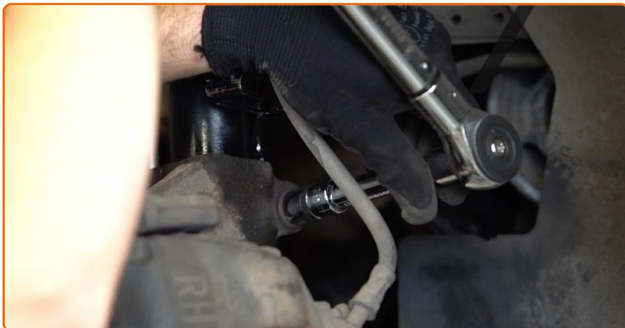
Instale e aperte um parafuso novo à manga do eixo. Use uma chave soquete nº 18. Use uma chave de catraca. Use uma chave de torque. Aperte-o para o torque de 110 Nm.
