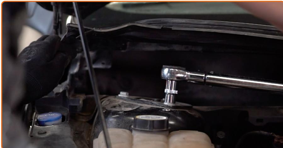
Apertar o suporte superior do amortecedor (3 peças). Use uma chave soquete nº 13. Use uma chave de torque. Aperte-o para o torque de 15 Nm.
