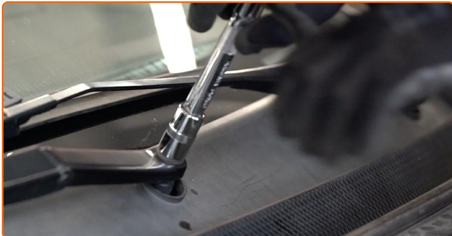
Desaperte os fixadores dos braços do limpa vidros do para-brisa. Use uma chave soquete nº 15. Use uma chave de catraca.
