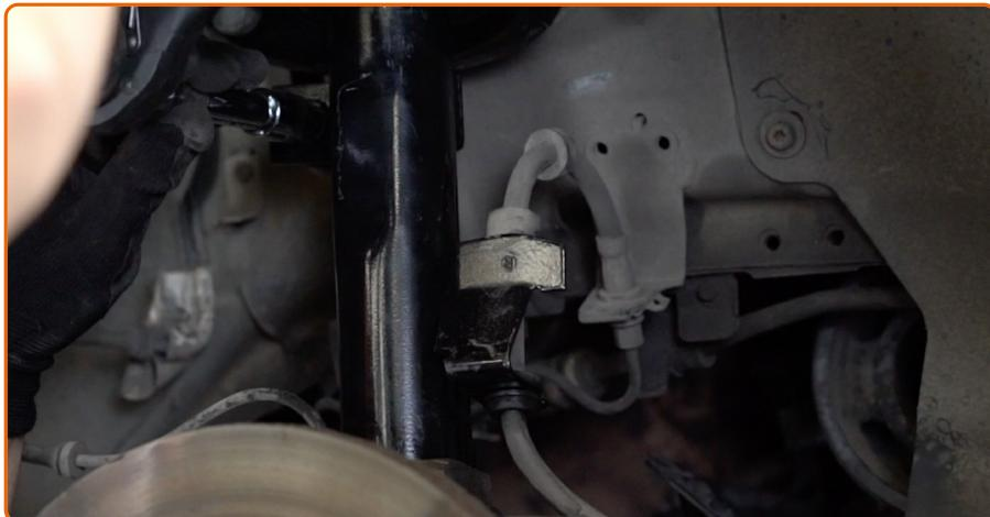
Fixe o tirante da barra estabilizadora do suporte de suspensão. Use uma chave soquete nº 15. Use uma chave de torque. Aperte-o para o torque de 65 Nm.
