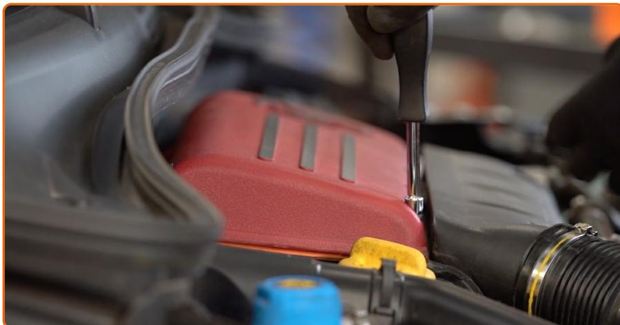
Desaperte os parafusos de fixação da tampa do filtro de ar (3 peças). Use uma chave soquete nº 8. Use uma chave de catraca.
