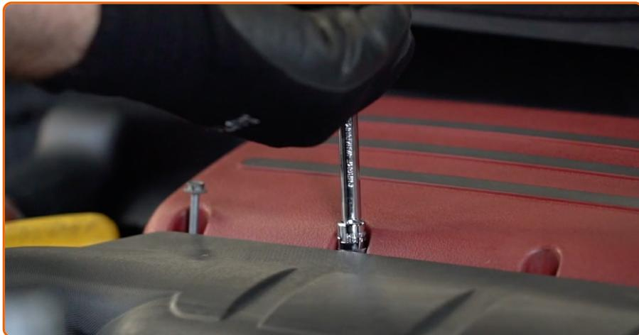
Aparafusar os parafusos de fixação da tampa do filtro de ar (3 peças). Use uma chave soquete nº 8. Use uma chave de catraca.
