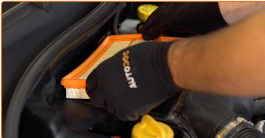
Insira um novo elemento de filtro na caixa do filtro. Certifique-se de que a borda do filtro encaixa-se perfeitamente na caixa.
