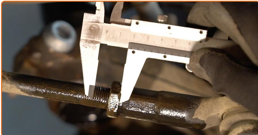
Ao desinstalar, marcar ou medir a posição precisa da articulação esférica na barra de direção, ou contar o número de voltas para evitar posteriormente o desalinhamento. Use um paquímetro.
