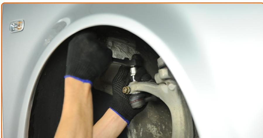
Aperte a porca de fixação conectada ao terminal de direção à manga de eixo. Use uma chave soquete nº 13. Use uma chave de torque. Aperte-o para o torque de 25 Nm.
