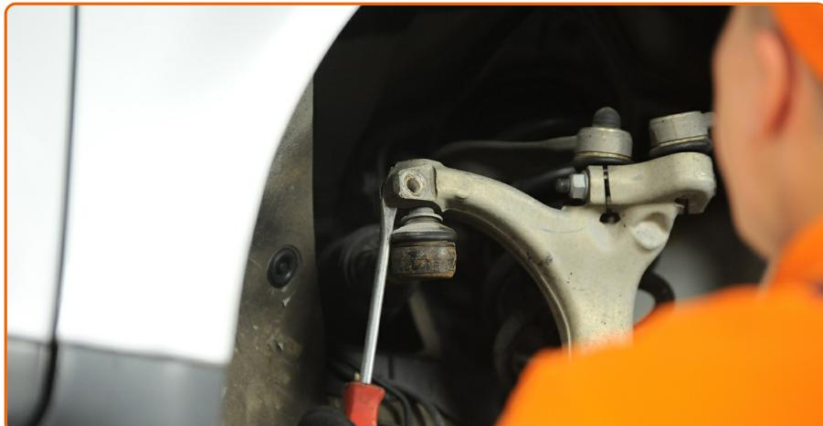
Desconecte o terminal de direção da manga de eixo. Use um cinzel plano para metal. Use um martelo.
