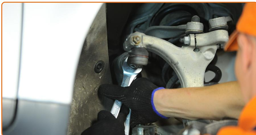
Apertar a porca de bloqueio do terminal de direção. Use uma chave combinada nº 19. Use uma chave combinada nº 22. Use uma chave de torque. Aperte-o para o torque de 65 Nm.
