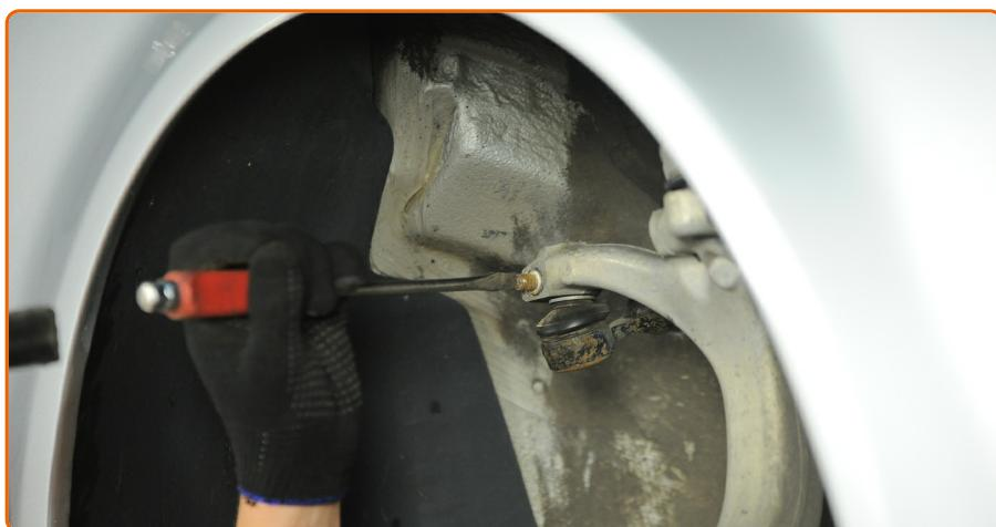
Remova o parafuso de fixação. Use um cinzel plano para metal. Use um martelo.
