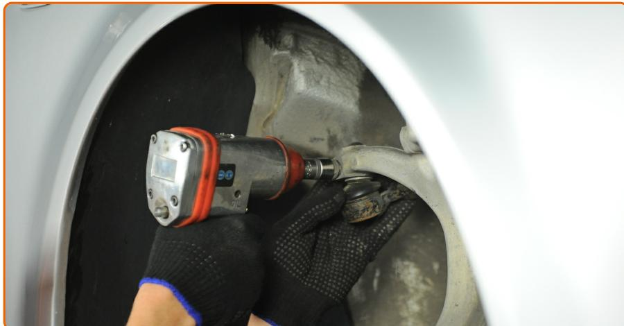
Desenrosque a extremidade da porca de fixação da manga de eixo. Use uma chave soquete nº 16. Use uma chave de catraca.
