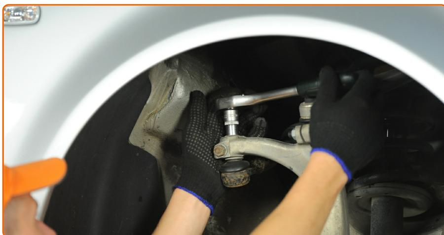
Desenrosque a extremidade da porca de fixação da manga de eixo. Use uma chave soquete nº 13. Use uma chave de catraca.
