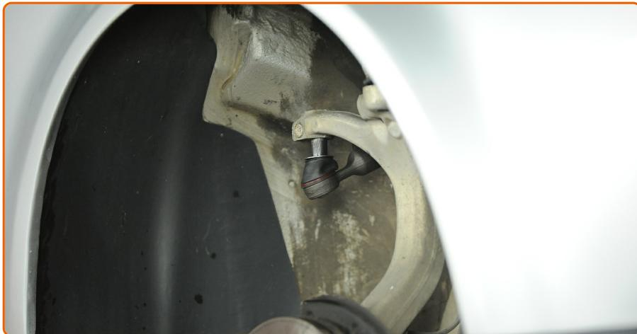
Conecte a extremidade do terminal de direção à manga de eixo. Use um martelo.
