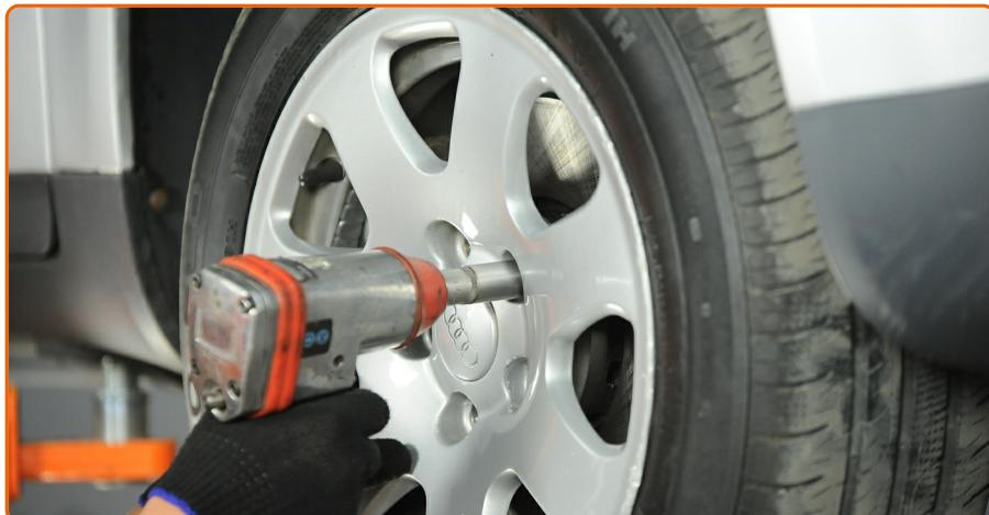
Desaperte os parafusos da roda.
