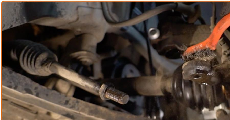
Limpe os assentos de montagem do terminal da direção. Use uma escova metálica. Use spray WD-40.
