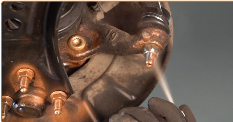
Trate a porca de fixação conectada ao terminal de direção à manga de eixo. Use massa de cobre.
