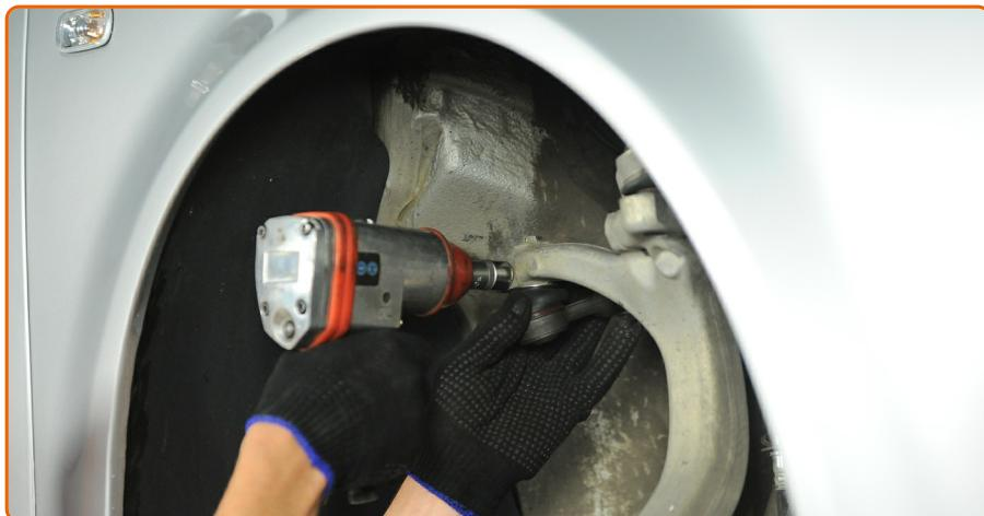
Aperte a porca de fixação conectada ao terminal de direção à manga de eixo. Use uma chave soquete nº 16. Use uma chave de torque. Aperte-o para o torque de 65 Nm.
