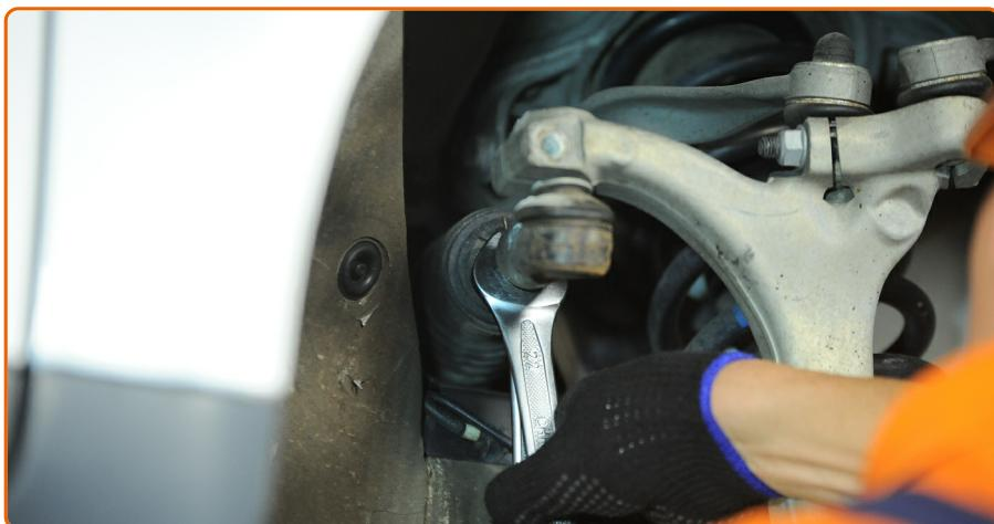
Solte a porca de bloqueio que prende o terminal de direção à barra de direção. Use uma chave combinada nº 19. Use uma chave combinada nº 22.
