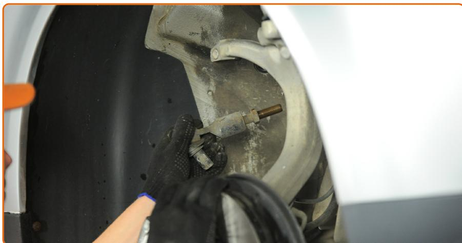
Desaparafuse a extremidade da barra de direção
