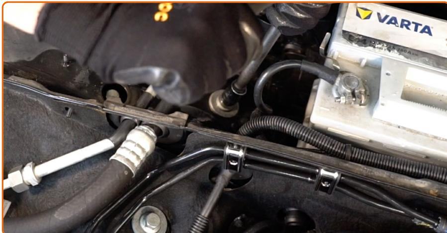
Solte o fixador superior do apoio da coluna de suspensão. Use uma chave soquete nº 16. Use uma chave de catraca.
