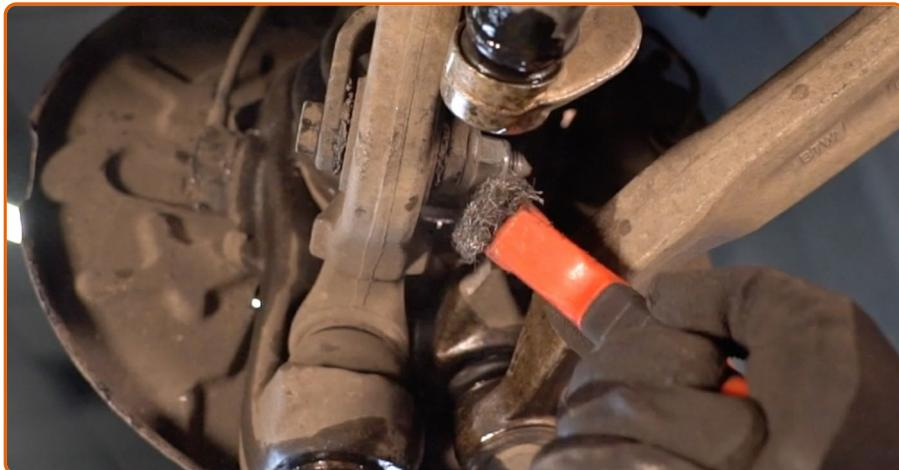
Limpe os elementos de fixação da coluna do amortecedor. Use uma escova metálica. Use spray WD-40.
