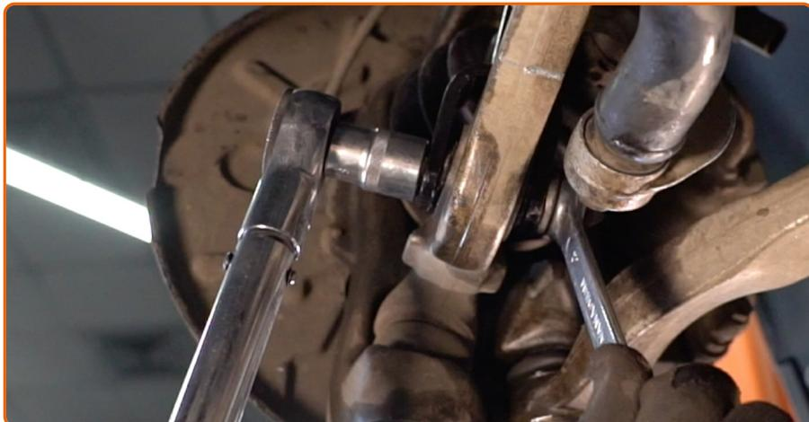
Aperte a fixação inferior do amortecedor. Use uma chave soquete nº 18. Use uma chave de torque. Aperte-o para o torque de 90 Nm.
