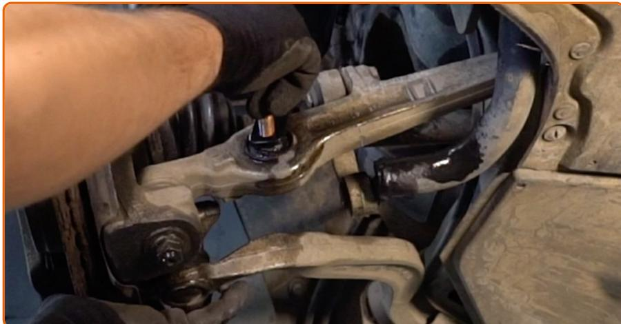
Instale o parafuso de fixação.
