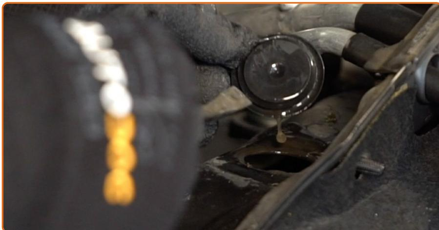
Remova a tampa do apoio da coluna de suspensão. Utilize um pé-de-cabra.
