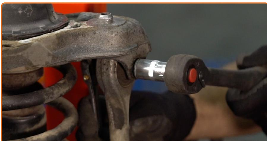
Desaparafuse os fixadores que ligam os braços de suspensão ao suporte do amortecedor. Use uma chave combinada nº 16. Use uma chave soquete nº 16. Use uma chave de catraca.
