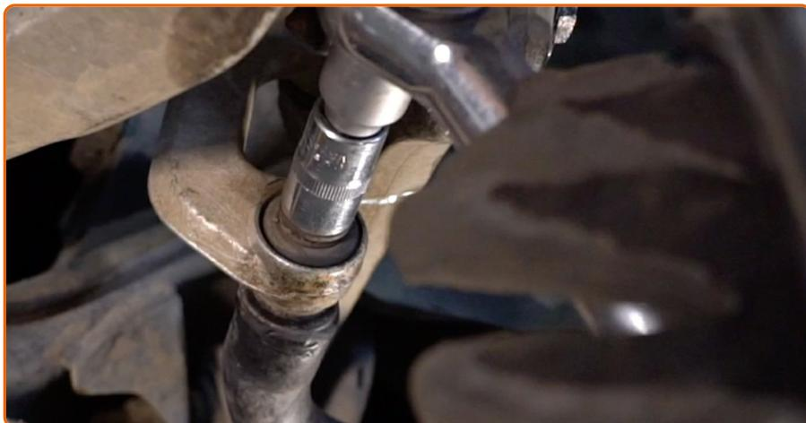
Aperte o fixador que conecta a bieleta da barra estabilizadora à barra estabilizadora. Use uma chave combinada nº 16. Use uma chave soquete nº 16. Use uma chave de torque. Aperte-o para o torque de 65 Nm.
