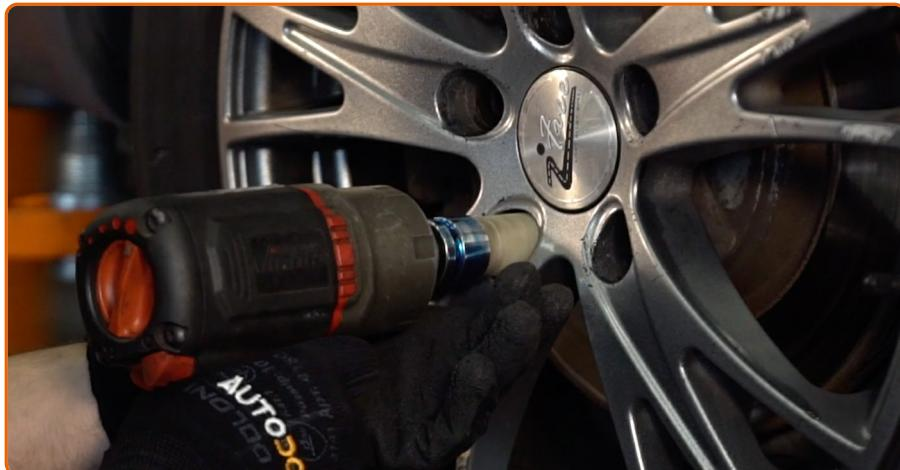
Desaperte os parafusos da roda.
