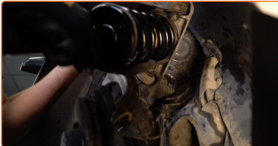
Instale o amortecedor no arco da roda.
