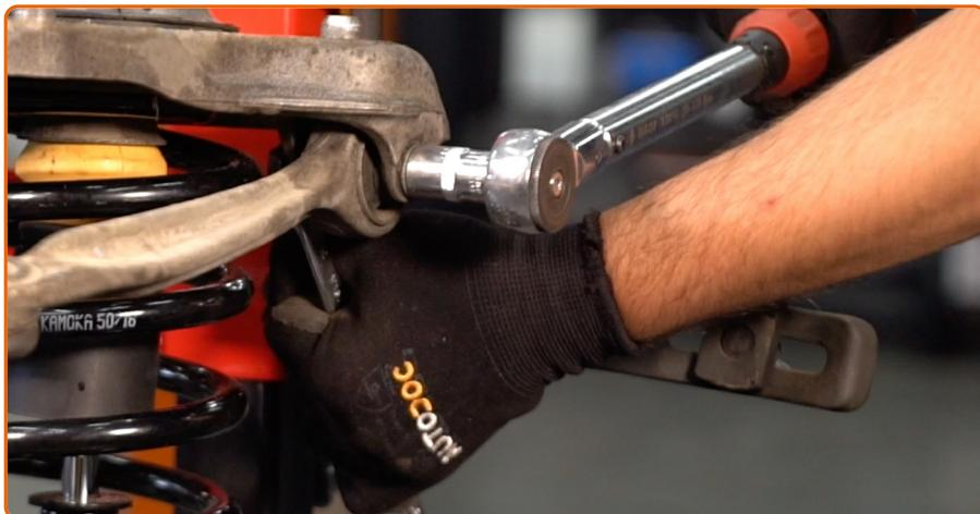
Aperte os fixadores que ligam os braços de suspensão ao suporte do amortecedor. Use uma chave combinada nº 16. Use uma chave soquete nº 16. Use uma chave de torque. Aperte-o para o torque de 80 Nm.
