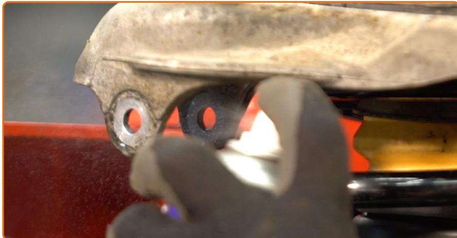
Limpe os locais de montagem e a rosca do braço da suspensão. Use uma escova metálica. Use spray WD-40.
