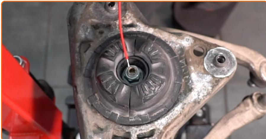
Trate a haste da coluna do amortecedor. Use spray WD-40.
