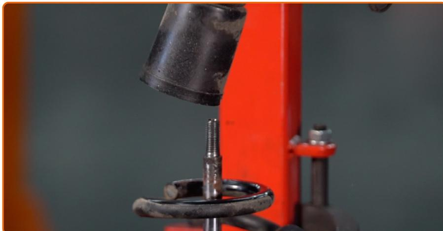
Remova o suporte do amortecedor, a coifa e o batente de encosto do amortecedor.
