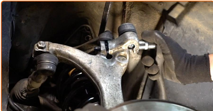
Aparafuse os fixadores (duas peças) do braço de suspensão superior. Use uma chave combinada nº 18. Use uma chave soquete nº 18.
