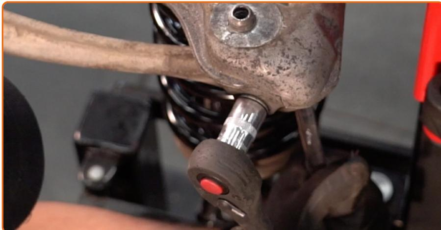
Aparafuse os fixadores que ligam os braços de suspensão ao suporte do amortecedor. Use uma chave combinada nº 16. Use uma chave soquete nº 16. Use uma chave de catraca.
