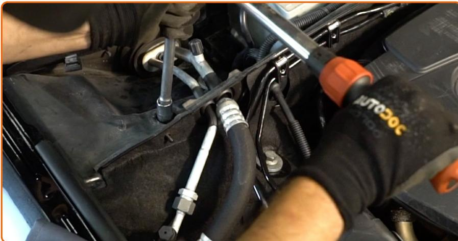
Aperte a fixação superior da montagem do suporte do amortecedor. Use uma chave soquete nº 16. Use uma chave de torque. Aperte-o para o torque de 65 Nm.
