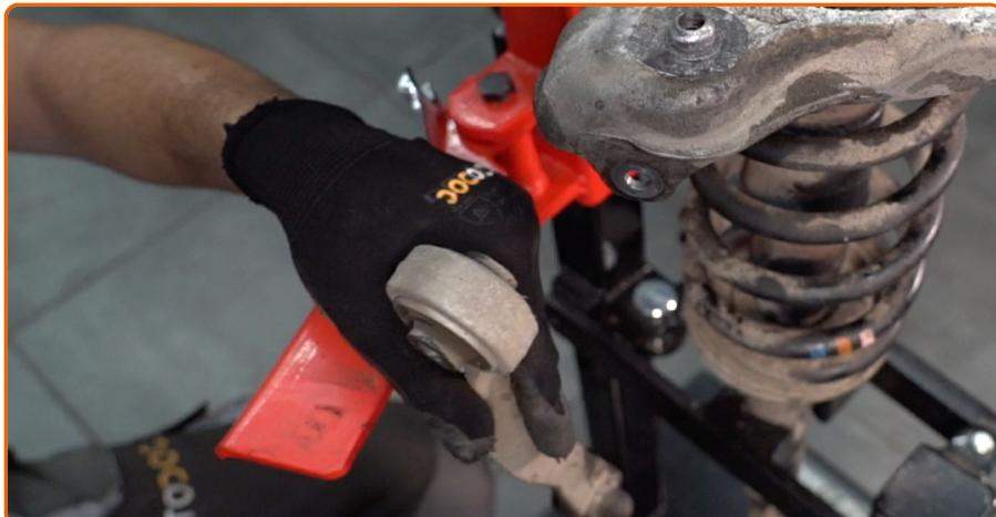
Remova o parafuso de fixação.
