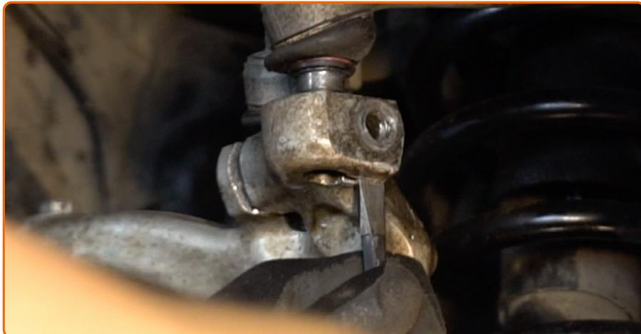
Solte o elemento fixador que liga a junta esférica do braço de suspensão à manga do eixo. Use um cinzel plano para metal. Use um martelo.
