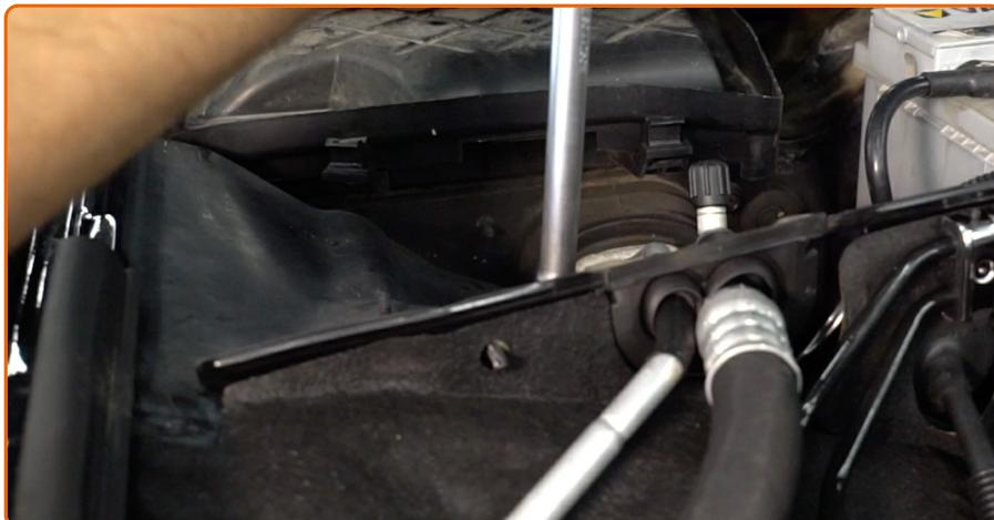
Aparafuse a fixação superior de montagem do suporte do amortecedor Use uma chave soquete nº 16. Use uma chave de catraca. Não o aperte.
