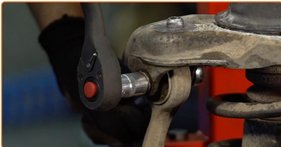
Desaparafuse os fixadores que ligam os braços de suspensão ao suporte do amortecedor.
