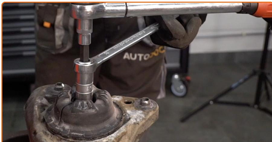
Aperte a porca do suporte do amortecedor da haste do pistão. Use HEX n.º H6. Use uma chave soquete nº 16. Use uma chave de torque. Aperte-o para o torque de 60 Nm.
