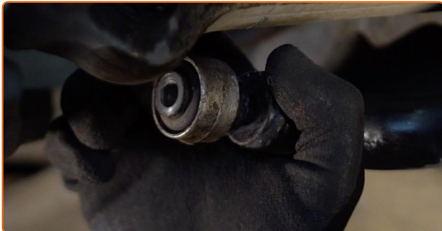
Instale o terminal do estabilizador transversal.
