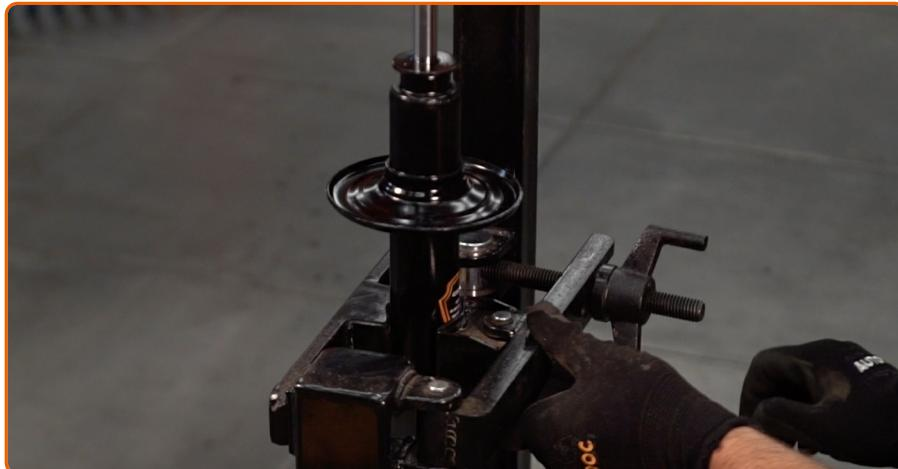
Instale o amortecedor novo no compressor hidráulico de mola.
