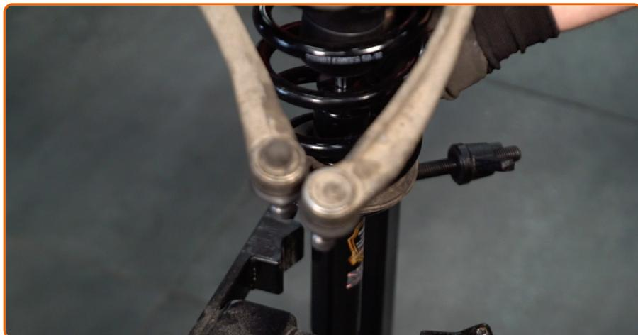
Retire a coluna de suspensão montada.
