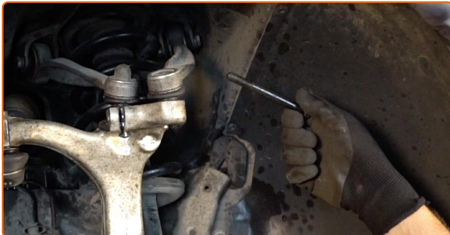
Remova o parafuso de fixação.
