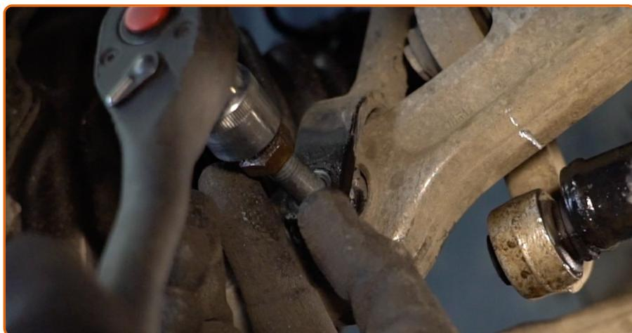
Remova o parafuso de fixação.
