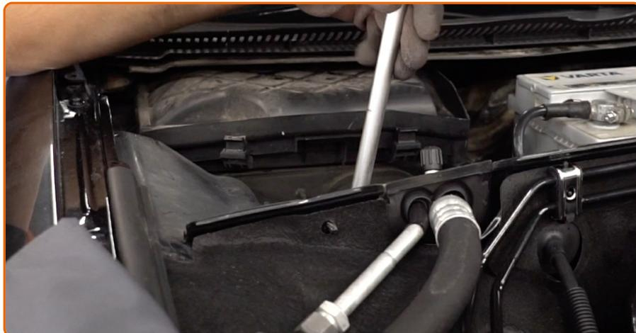
Desapertar a fixação superior de montagem do suporte do amortecedor. Use uma chave de soquete nº 16. Use uma chave de catraca.
