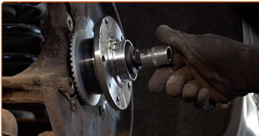
Instale o parafuso de fixação.
