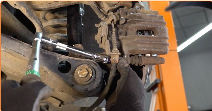
Instale a pinça do travão e fixe-o. Use uma chave soquete nº 13. Use uma chave combinada nº 15. Use uma chave de torque. Aperte-o para o torque de 35 Nm.
