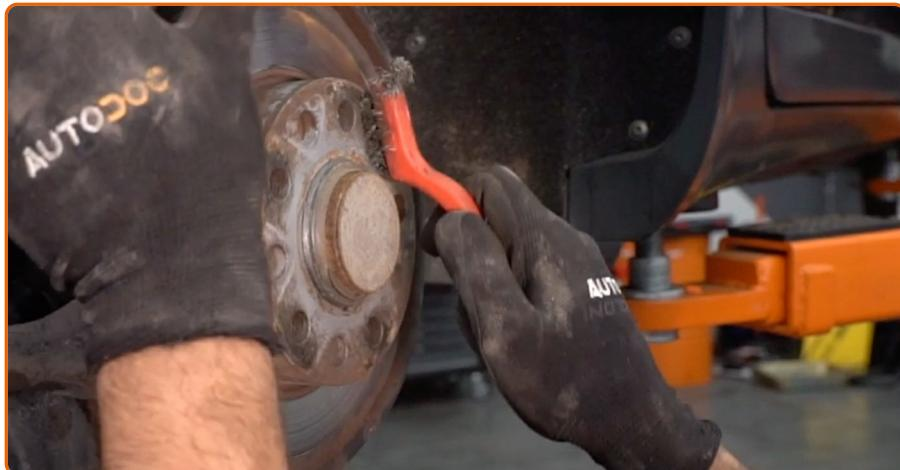
Limpe os elementos de fixação do disco de travão. Use uma escova metálica. Use spray WD-40.
