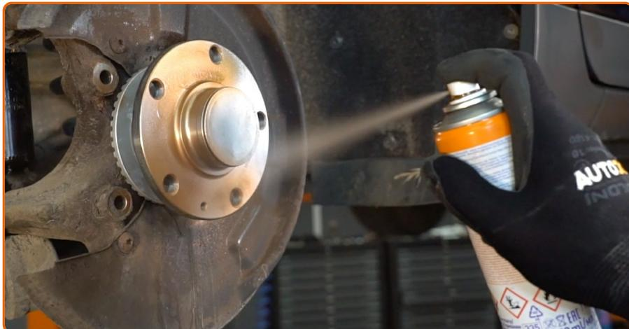
Trate o cubo onde entra em contacto com o disco de travão. Use massa de cobre.
