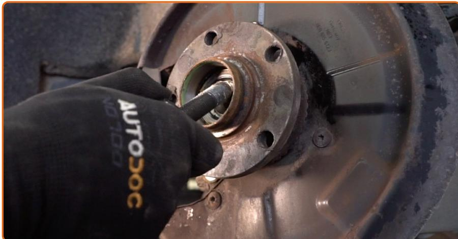
Remova o parafuso de fixação.
