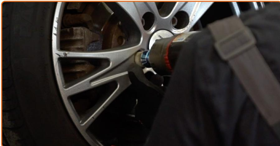
Desaperte os parafusos da roda.
