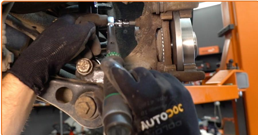
Aperte a braçadeira da pinça do travão. Use HEX n.º H8 Use uma chave de torque. Aperte-o para o torque de 45 Nm.
