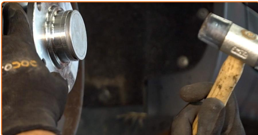
Instale a tampa de proteção do rolamento do cubo. Use um martelo de borracha.
