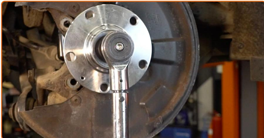
Aperte os elementos de fixação do rolamento do cubo da roda. Use HEX n.º H19. Use uma chave de torque. Aperte-o para o torque de 145 Nm.
