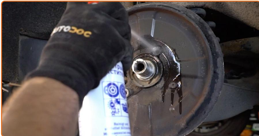
Limpe o local de montagem do rolamento de cubo. Use o spray de limpeza universal.
