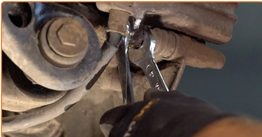
Desaparafuse a fixação de pinça de travão. Use uma chave combinada nº 13. Use uma chave combinada nº 15.
