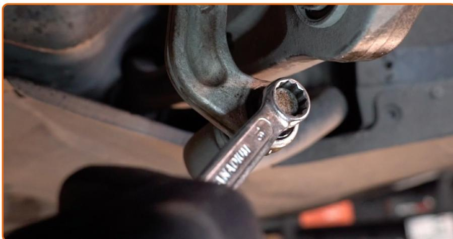
Desaparafuse os fixadores que conectam a bieleta da barra estabilizadora. Use uma chave combinada nº 16. Use uma chave soquete nº 16. Use uma chave de catraca.
