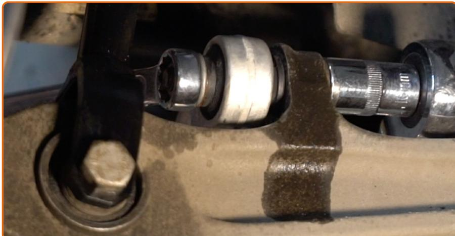
Instale a fixação da haste à barra estabilizadora e aperte-a. Use uma chave combinada nº 16. Use uma chave soquete nº 16. Use uma chave de torque. Aperte-o para o torque de 65 Nm.
