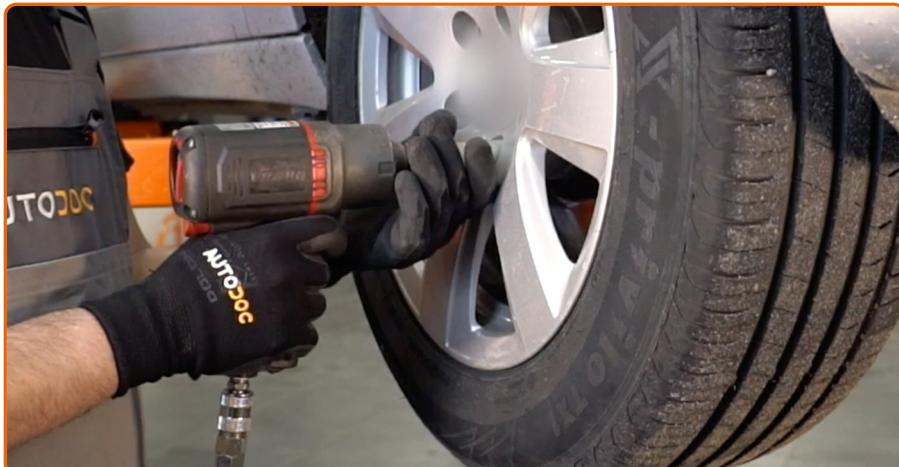
Desaperte os parafusos da roda.
