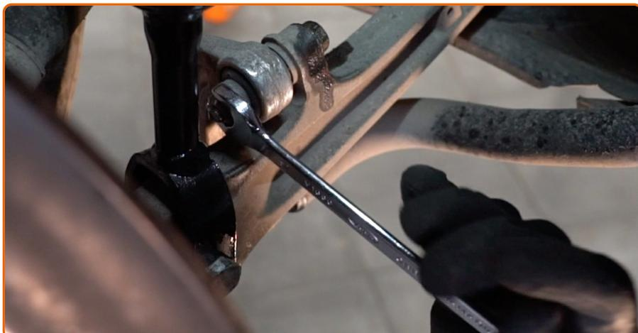
Desaparafuse o fixador que conecta a barra estabilizadora ao braço. Use uma chave combinada nº 16.
