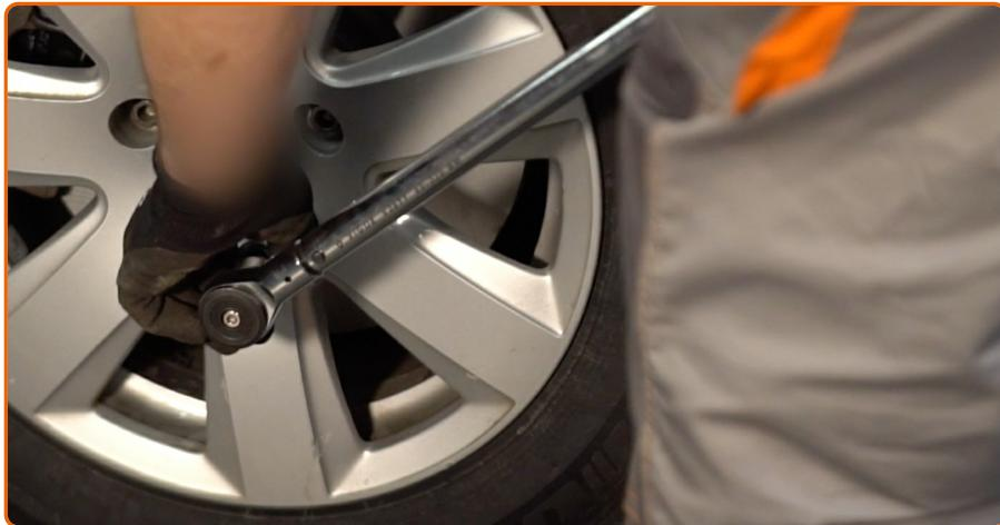
Baixar o carro e trabalhar em ordem transversal, apertar os parafusos das rodas. Use uma chave de torque. Aperte-o para o torque de 120 Nm.
