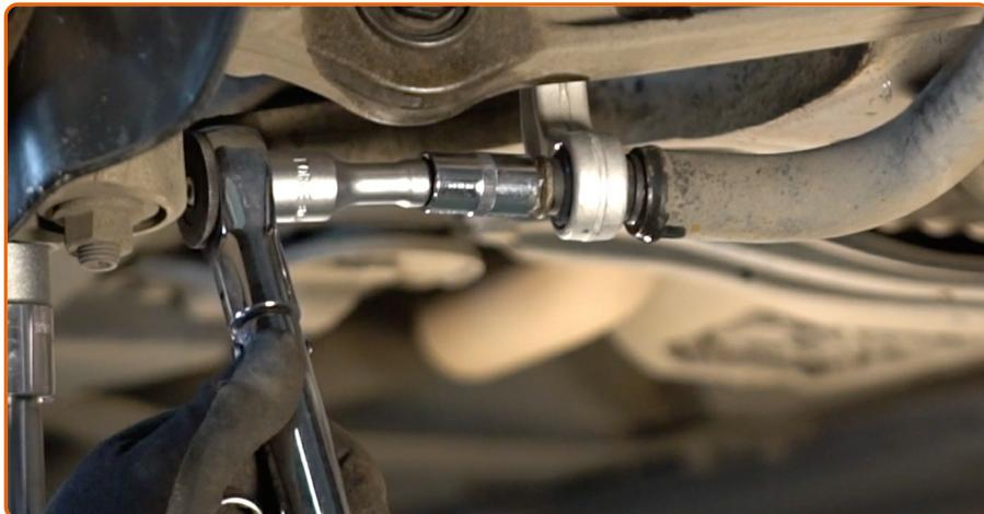
Aperte o fixador que conecta a bieleta da barra estabilizadora à barra estabilizadora. Use uma chave combinada nº 16. Use uma chave soquete nº 16. Use uma chave de torque.
