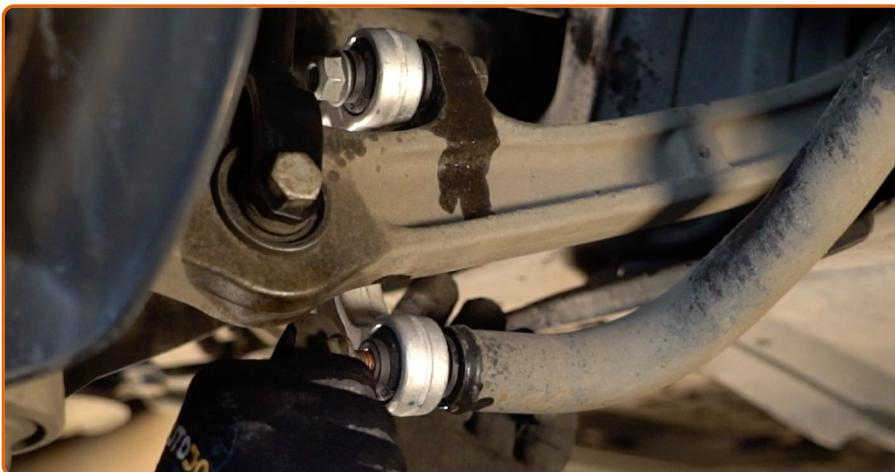
Instale uma nova barra, aperte os parafusos de fixação. Utilize um pé-de-cabra.
