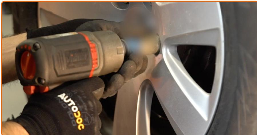
Aperte os parafusos da roda. Use o soquete de impacto para roda #17.
