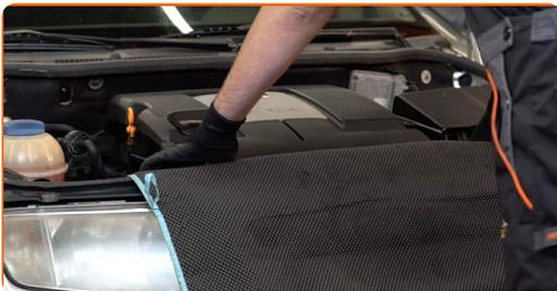
3 Retire a tampa do motor. A caixa do filtro de ar está integrado na tampa do motor.
