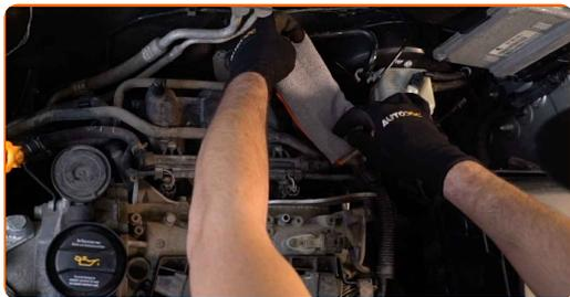
5 Desaperte os parafusos de fixação da tampa do filtro de ar. Use a chave Phillips.
