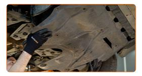
Limpe a área do orifício de drenagem do cárter. Use uma escova metálica. Use o spray de limpeza universal.
