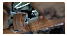
Aparafuse o novo bujão de drenagem e aperte-o. Use HEX n.º H17. Use uma chave de torque. Aperte-o para o torque de 32 Nm.
