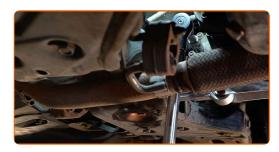
Limpe a área ao redor do orifício de enchimento da caixa de velocidades. Use o spray de limpeza universal.
