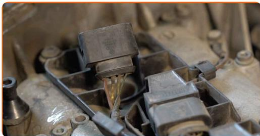
**9** Limpe a sujidade, poeira e detritos de dentro dos poços das velas de ignição.
