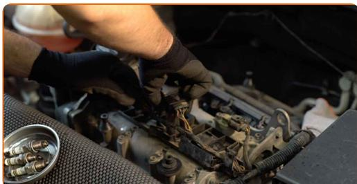
**Substituição: vela de ignição – Skoda Fabia 6Y5. Conselho:**
