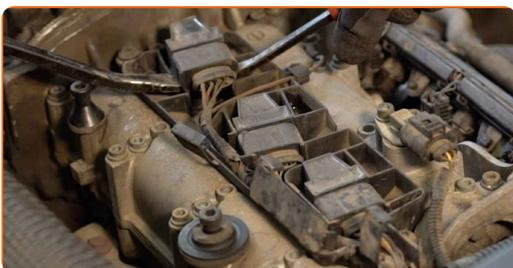
**7** Retire a bobina de ignição do orifício da vela de ignição.
