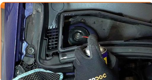
**6** Solte o fixador superior do apoio da coluna de suspensão. Use uma chave soquete n° 21. Use HEX n.º H7 Use uma chave de catraca.
