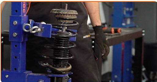
**49** Retire a coluna de suspensão montada.
