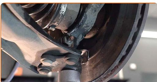
**63** Aparafuse o fixador que conecta o amortecedor à manga de eixo. Use uma chave soquete nº 18.
