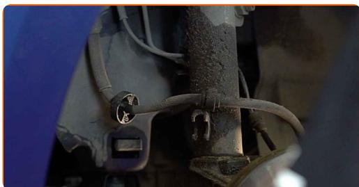
**14** Limpe os elementos de fixação da coluna do amortecedor. Use uma escova metálica. Use spray WD-40.
