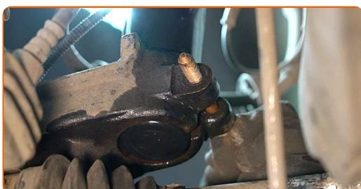
**61** Instale e aperte um parafuso novo à manga do eixo.
