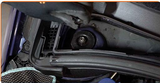
**5** Limpe os fixadores da montagem superior do suporte do amortecedor. Use uma escova metálica. Use spray WD-40.
