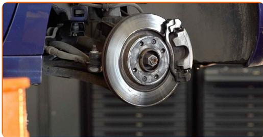
**13** Desligue a instalação elétrica e a mangueira do travão do braço de suporte do amortecedor.
