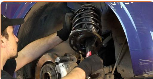
**51** Aparafuse a fixação superior de montagem do suporte do amortecedor. Não o aperte.
