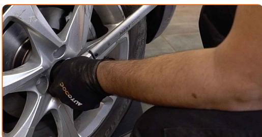
**81** Apertar os parafusos da roda usando um padrão cruzado. Use uma chave de torque. Aperte-o para o torque de 100 Nm.
