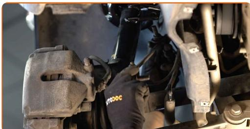
**Substituição: tirante da barra estabilizadora – VW Touran 1T1 1T2.** Os profissionais recomendam:
