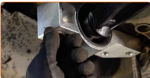
**22** Aperte o fixador traseiro que liga o braço da suspensão à carroçaria. Use uma chave soquete nº 18. Use uma chave de catraca.
