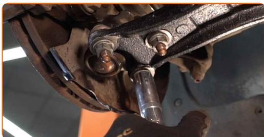
**25** Aperte o fixador da articulação esférica. Use uma chave soquete nº 16. Use uma chave de torque. Aperte-o para o torque de 60 Nm.
