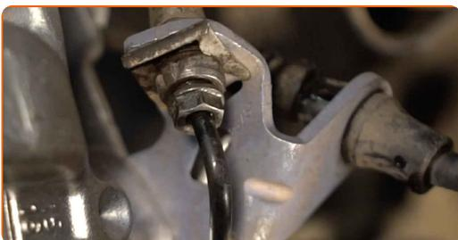
**29** Instale o clip de retenção da mangueira do travão. Use um martelo de borracha.
