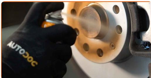
**38** Limpe a superfície do disco de travão. Utilize um produto de limpeza para travões.
