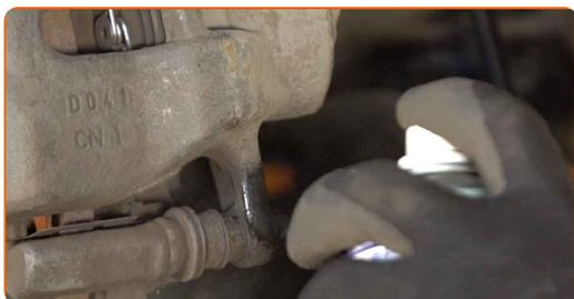
**8** Desaparafuse a fixação de pinça de travão. Use uma chave combinada nº 13. Use uma chave combinada nº 15.
