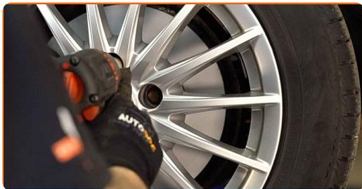
**23** Baixe o carro e trabalhe em ordem transversal, apertar os parafusos das rodas. Use uma chave de torque. Aperte-o para o torque de 120 Nm.
