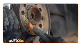
Desaperte a fixação do disco de travão. Use HEX n.º H5. Use uma chave de catraca.
