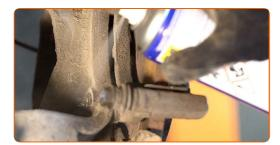
Desaperte a fixação da braçadeira da pinça. Use uma chave soquete nº E12. Use uma chave de catraca.
