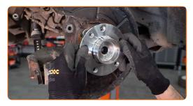
24 Instale os parafusos de fixação.
