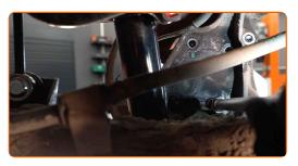
Retire os parafusos de fixação.
