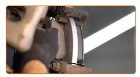
Instale a pinça do travão e fixe-o. Use uma chave combinada nº 13. Use uma chave combinada nº 15. Use uma chave soquete nº 13. Use uma chave de torque. Aperte-o para o torque de 35 Nm.
