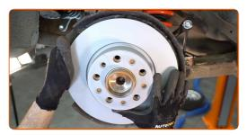
Aperte a fixação do disco de travão. Use HEX n.º H5. Use uma chave de torque. Aperte-o para o torque de 7 Nm.
