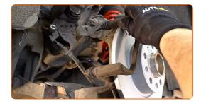
Aperte a braçadeira da pinça do travão. Use uma chave soquete nº E12. Use uma chave de torque. Aperte-o para o torque de 60 Nm.
