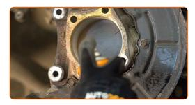
23 Instale o novo cubo da roda com um rolamento.
