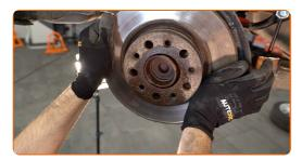
Limpe a fixação do cubo da roda. Use uma escova metálica. Use spray WD-40.
