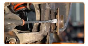
Limpe o local de montagem do rolamento de cubo. Use uma escova metálica. Use o spray de limpeza universal.
