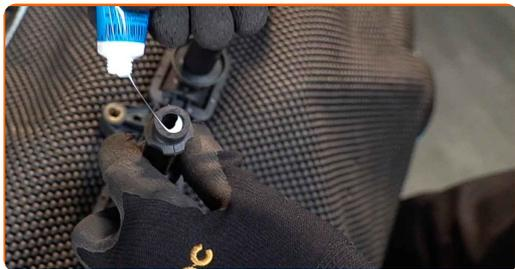
**13** Instale a bobina de ignição no orifício da vela de ignição. Certifique-se que ouve um clique a indicar que está fixa no local.
