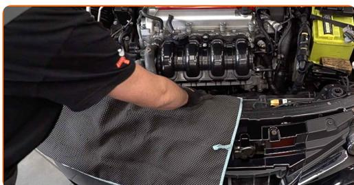
**3** Desaperte os parafusos da cobertura do motor (4 peças). Use uma chave soquete nº 8. Use uma chave de catraca.
