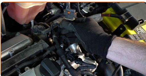
**6** Desaperte o suporte da bobina de ignição. Use uma chave soquete nº 10. Use uma chave de catraca.
