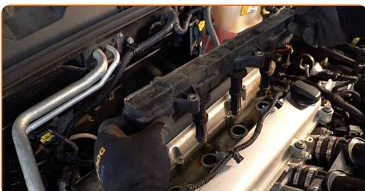
**8** Limpe a sujidade, poeira e detritos de dentro dos poços das velas de ignição. Desaperte as velas de ignição. Use o soquete da vela de ignição #16. Use uma chave de catraca.
