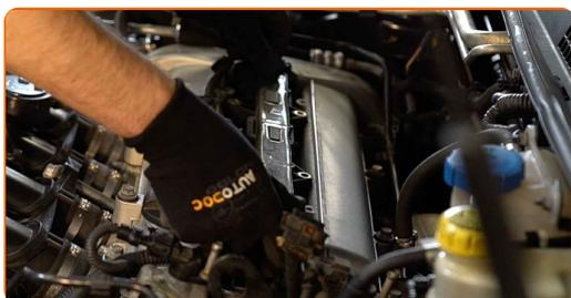
**14** Apertar a fixação da bobina de ignição. Use uma chave soquete nº 10. Use uma chave de torque. Aperte-o para o torque de 8 Nm.
