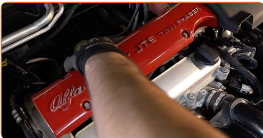
**5** Desconecte o conector da bobina de ignição. Use uma chave de fenda plana.
