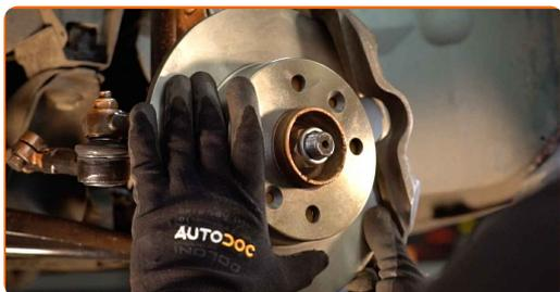
**19** Aperte a fixação do disco de travão. Use Torx T30. Use uma chave de torque. Aperte-o para o torque de 15 Nm.
