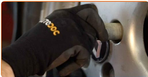
**27** Baixar o carro e trabalhar em ordem transversal, apertar os parafusos das rodas. Use uma chave de torque. Aperte-o para o torque de 90 Nm.
