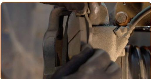
**11** Limpe os elementos de fixação do disco de travão. Use uma escova metálica. Use spray WD-40.
