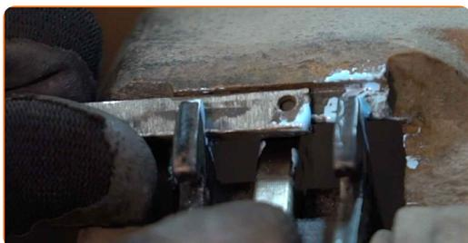
**22** Instale o pino de retenção da pastilha de travão. Use alicates de ponta arredondada.
