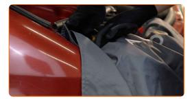
Remova a tampa do apoio da coluna de suspensão.
