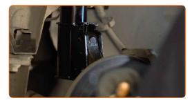
Instale os parafusos de fixação.
