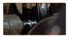
Aperte os fixadores inferiores que conectam a coluna de suspensão à manga de eixo. Use uma chave combinada nº 18. Use uma chave soquete nº 18. Use uma chave de torque. Aperte-o para o torque de 110 Nm.
