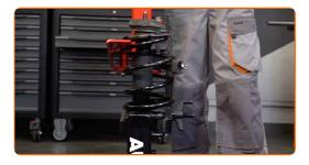
Retire a coluna de suspensão montada.
