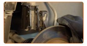
Desapertar a fixação superior de montagem do suporte do amortecedor. Use uma chave soquete nº 21.
