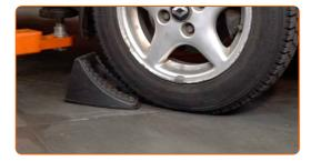
Solte os parafusos de montagem das rodas. Use o soquete de impacto para roda #17.
