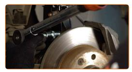
Trate os fixadores do amortecedor. Use massa de cobre.
