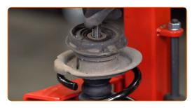
Aperte a porca do suporte do amortecedor da haste do pistão. Use uma chave soquete nº 17. Use HEX n.º H6. Use uma chave de torque. Aperte-o para o torque de 25 Nm.
