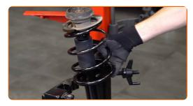
Instale o amortecedor no arco da roda.
