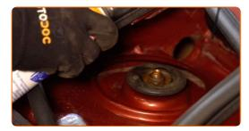
Instale a tampa do apoio da coluna de suspensão.
