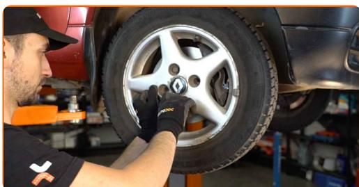
**37** Baixar o carro e trabalhar em ordem transversal, apertar os parafusos das rodas. Use uma chave de torque. Aperte-o para o torque de 90 Nm.
