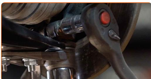
**26** Aparafuse o fixador traseiro que liga o braço da suspensão ao subchassi. Use uma chave combinada nº 19. Use uma chave soquete nº 19. Use uma chave de tarraxa.
