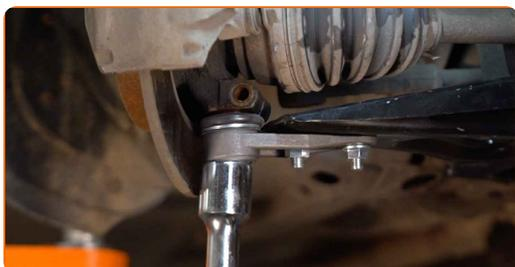
**24** Instale o parafuso de fixação. Use um martelo de borracha.
