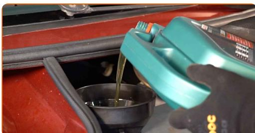
**Substituição: óleo do motor e filtro – Renault Twingo C06. AUTODOC recomenda:**
