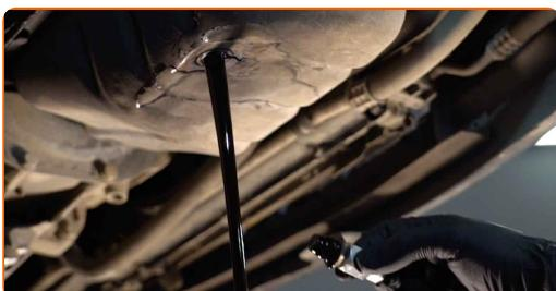
**Substituição: óleo do motor e filtro – Renault Twingo C06. Conselho da AUTODOC:**
