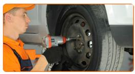
Baixar o carro e trabalhar em ordem transversal, apertar os parafusos das rodas. Use o soquete de impacto para roda #19. Use uma chave de torque. Aperte-o para o torque de 120 Nm.
