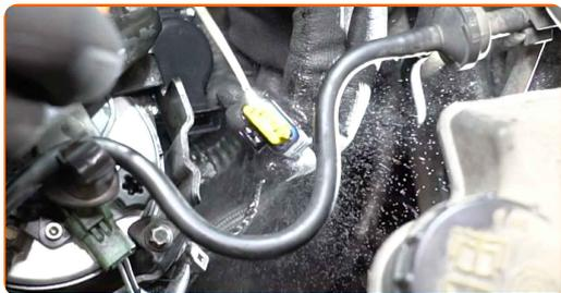
**17** Encaixe o conector da válvula EGR.
