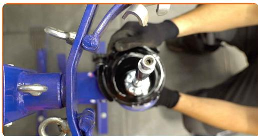
**35** Instale a manga para poeiras e a bomba de bloqueio no novo amortecedor.
