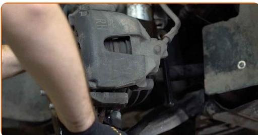
24 Desaperte a fixação do suporte superior do braço do amortecedor.
