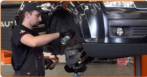
40 Instale o amortecedor no arco da roda.
