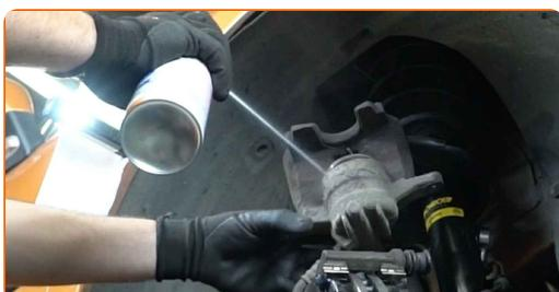
Substituição: discos de travão – Peugeot 207 hatchback. AUTODOC recomenda:
