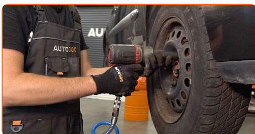
**22** Baixar o carro e trabalhar em ordem transversal, apertar os parafusos das rodas. Use uma chave de torque. Aperte-o para o torque de 90 Nm.
