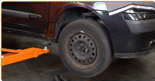
**5** Desaperte os parafusos da roda.
