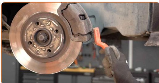
**8** Desaparafuse a fixação de pinça de travão. Use uma chave combinada nº 13. Use uma chave combinada nº 17.
