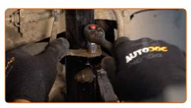
Aperte os fixadores inferiores que conectam a coluna de suspensão à manga de eixo. Use uma chave combinada nº 18. Use uma chave soquete nº 18. Use uma chave de torque. Aperte-o para o torque de 110 Nm.
