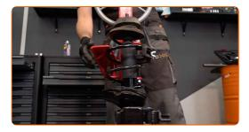
Retire a coluna de suspensão montada.
