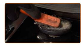
Solte o fixador superior do apoio da coluna de suspensão. Use HEX n.º H6. Use uma chave combinada nº 21. Use uma chave de catraca.
