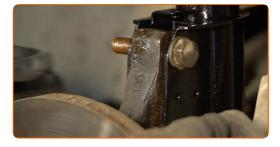
Aparafuse o fixador que conecta o amortecedor à manga de eixo. Use uma chave combinada nº 18. Use uma chave soquete nº 18.
