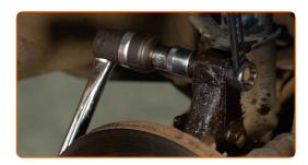
Desaperte o suporte do cabo ABS. Use uma chave soquete nº 10. Use uma chave de catraca.
