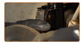
36 Instale os parafusos de fixação.
