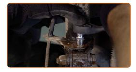
Retire os parafusos de fixação.
