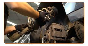
Coloque o suporte do amortecedor sobre a ferramenta de compressão da mola.
