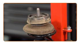
Aperte a porca do suporte do amortecedor da haste do pistão. Use uma chave soquete nº 17. Use HEX n.º H6. Use uma chave de torque. Aperte-o para o torque de 21 Nm.
