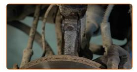
Desligar a manga de eixo do suporte do amortecedor. Use uma chave combinada nº 18.
