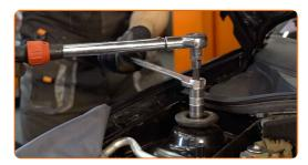
Trate os fixadores do apoio da coluna de suspensão. Use massa de cobre.
