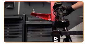
Instale o amortecedor no arco da roda.
