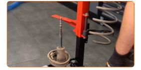
Instale a coifa e o batente de encosto no amortecedor.
