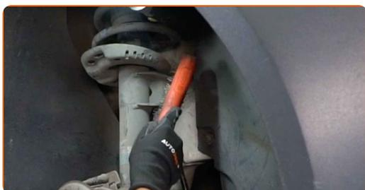
**7** Desaparafuse o fixador que conecta a bieleta da barra estabilizadora à barra estabilizadora. Use uma chave combinada nº 18.
