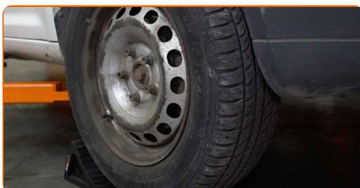
**4** Desaperte os parafusos da roda.
