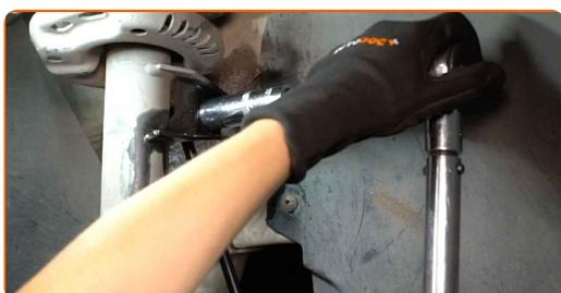
**13** Aperte o fixador que conecta a bieleta da barra estabilizadora à barra estabilizadora. Use uma chave combinada nº 15. Use uma chave soquete nº 19. Use uma chave de torque. Aperte-o para o torque de 60 Nm.
