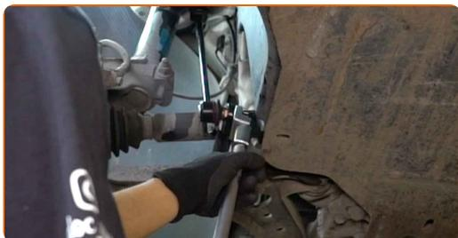
**14** Trate todas as juntas de conexão do estabilizador. Use massa de cobre.
