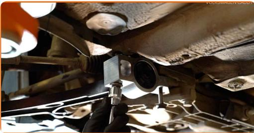
**Substituição: braço inferior da parte dianteira – VW Caddy 3 Kombi. AUTODOC recomenda:**
