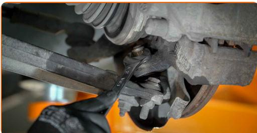
9 Desaperte a porca de fixação, retire o braço da manga de eixo usando um extrator de articulação esférica. Se necessário, utilize um pé-de-cabra.
