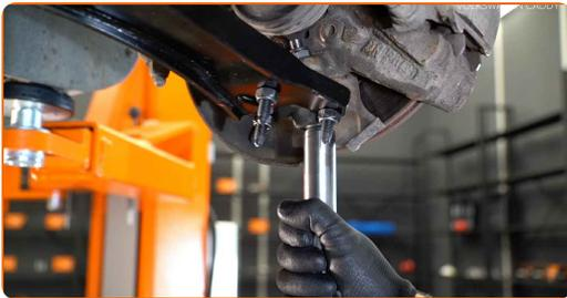
**18** Aperte o braço de fixação dianteiro. Use uma chave soquete n.º18 ou a chave de anel n.º18. Aperte-o para o torque de 70 Nm.+90°
