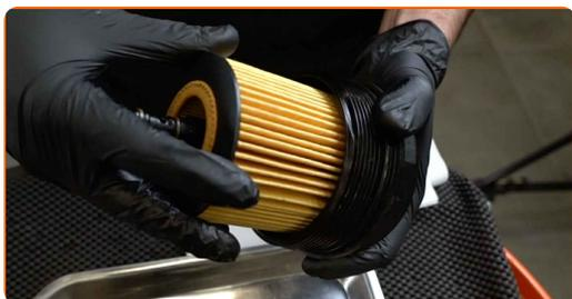
**18** Instale um novo anel O-ring no seu assento de montagem na tampa do filtro.
