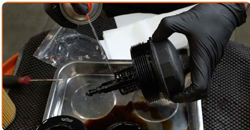
**17** Instale o novo filtro de óleo no assento de montagem na tampa do filtro.
