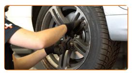
Baixar o carro e trabalhar em ordem transversal, apertar os parafusos das rodas. Use uma chave de torque. 54 Aperte-o para o torque de 120 Nm.
