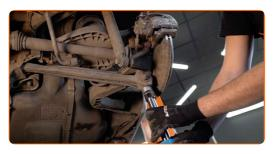
Limpe os elementos de fixação do amortecedor. Use uma escova metálica. Use spray WD-40.
