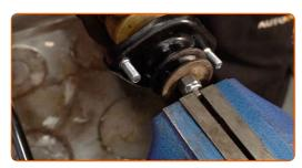
Aperte a fixação superior da haste do amortecedor. Use uma chave combinada nº 16. Use uma chave inglesa. Use uma chave de torque. Aperte-o para o torque de 20 Nm.
