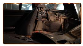
Limpe os fixadores do suporte superior do amortecedor. Use uma escova metálica. Use spray WD-40.
