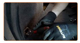
Aperte os fixadores laterais do painel de ventilação da bagageira. Use a chave Phillips. 42
