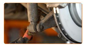
Desaperte a fixação inferior do amortecedor. Use uma chave soquete nº 18. Use uma chave de tarraxa.
