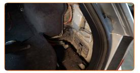
Desaperte os fixadores do painel de acabamento plástico lateral. Use Torx T25.
