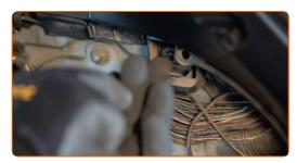
Instale o fixador plástico do forro lateral dianteiro da bagageira.
