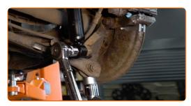
Apertar a fixação superior do amortecedor. Use uma chave soquete nº 13. Use uma chave de torque. Aperte-o para o torque de 28 Nm.
