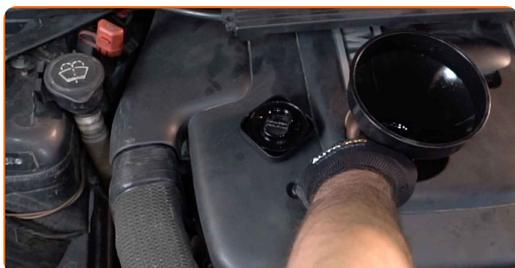
**31** Despeje o óleo no motor através do gargalo de enchimento de óleo. Quantidade necessária de óleo: 5.5 l.
