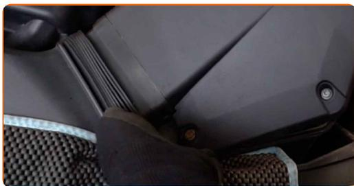
**11** Aparafusar os parafusos de fixação da tampa do filtro de ar. Use Torx T25. Use uma chave de catraca.
