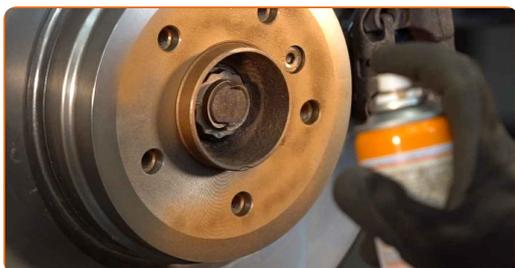
**37** Limpe a superfície do disco de travão. Utilize um produto de limpeza para travões.
