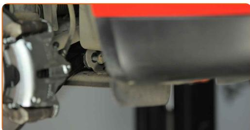
**38** Aperte o braço de fixação dianteiro. Use uma chave soquete nº 15. Use uma chave de catraca.
