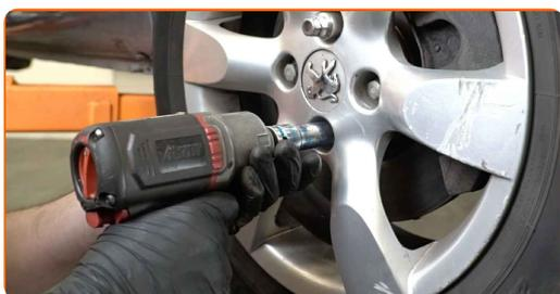
**73** Baixar o carro e trabalhar em ordem transversal, apertar os parafusos das rodas. Use o soquete de impacto para roda #17. Use uma chave de torque. Aperte-o para o torque de 100 Nm.
