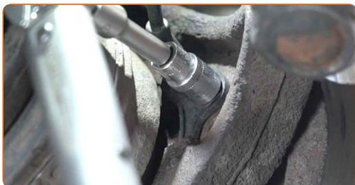
**66** Aperte o fixador da articulação esférica. Use uma chave soquete nº 21. Use uma chave de torque. Aperte-o para o torque de 50 Nm.
