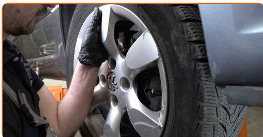
**Substituição: rolamento da roda – Peugeot 307 SW. Conselho da AUTODOC:**
