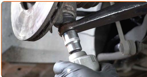
**64** Conecte o sensor de ABS à manga de eixo.
