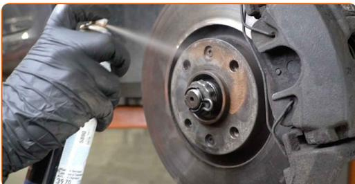
**70** Limpe a superfície do disco de travão. Utilize um produto de limpeza para travões.
