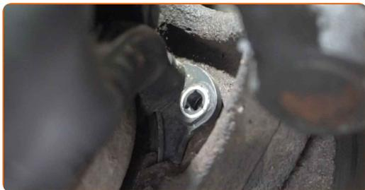
**65** Aperte o fixador que liga o sensor de ABS ao manga de eixo. Use uma chave soquete nº 10. Use uma chave de torque. Aperte-o para o torque de 11 Nm.
