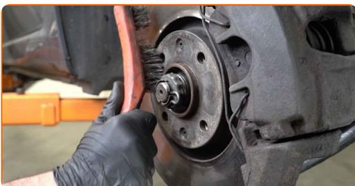
**69** Trate a superfície onde o disco de travão entra em contacto com o aro da roda. Use massa de cobre.
