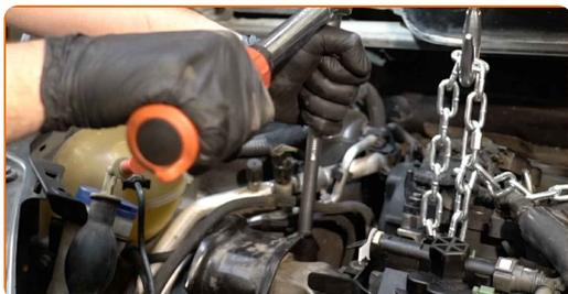
**114** Aperte os parafusos de fixação do apoio do motor. Use Torx T50. Use uma chave de torque. Aperte-o para o torque de 60 Nm.
