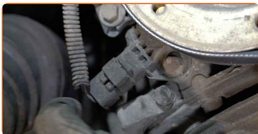
**30** Separe a cablagem do sensor de posição da cambota. Use uma ferramenta de remoção de clipe.
