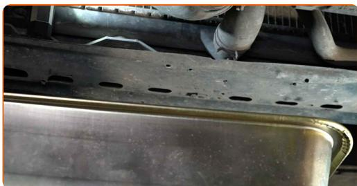
**57** Separe a braçadeira do tubo inferior do líquido de refrigeração. Utilize alicates de anel clic-R.
