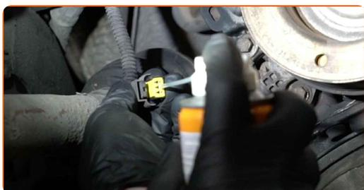
**102** Conecte o conector do sensor de posição da cambota.
