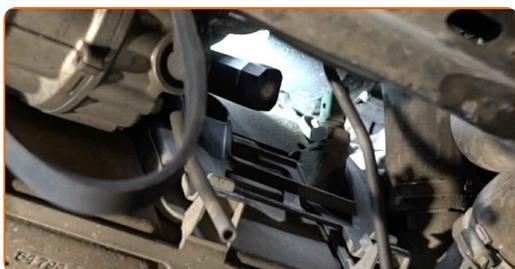
**101** Trate o conector do sensor de posição da cambota. Use o spray de limpeza universal.
