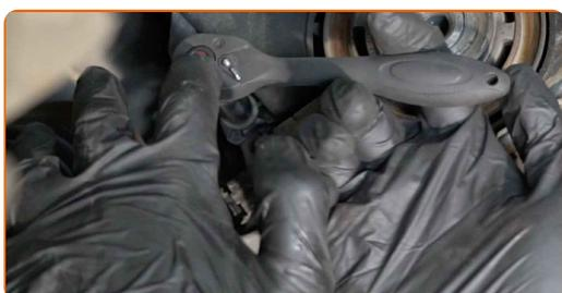
**43** Desaperte o fixador do sensor de posição da cambota. Use uma chave soquete nº 10. Use uma chave de catraca.
