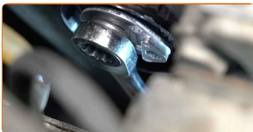
Substituição: bomba de água & kit de distribuição – Peugeot 307 SW.
