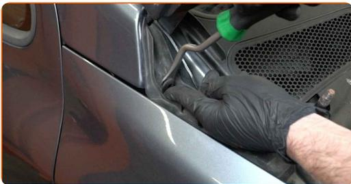
**8** Desaperte os fixadores do reservatório do líquido de travões. Use Torx T20. Use uma chave de catraca.
