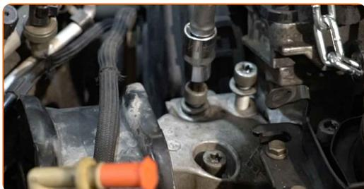
**112** Aparafuse os fixadores, que ligam o suporte do motor à carroçaria. Use uma chave soquete nº E14. Use uma chave de catraca.
