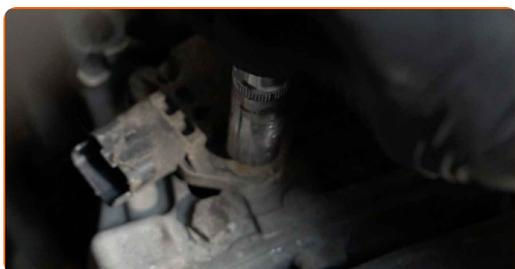
**44** Retire o sensor de posição da cambota.
