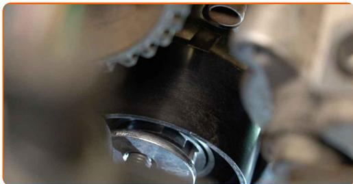
**76** Aparafuse o fixador da polia de tensão da correia de distribuição. Use uma chave combinada nº 13.
