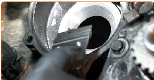
**66** Limpe a bomba de água. Use o spray de limpeza universal.
