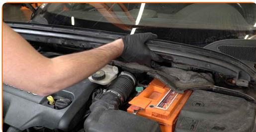
**11** Solte os retentores do reservatório de líquido de refrigeração. Use uma ferramenta de remoção de clipe.
