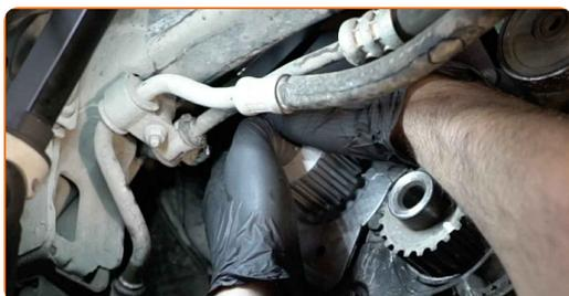
**70** Aparafuse os fixadores da bomba de água. Use uma chave soquete nº 11. Use uma chave de catraca.
