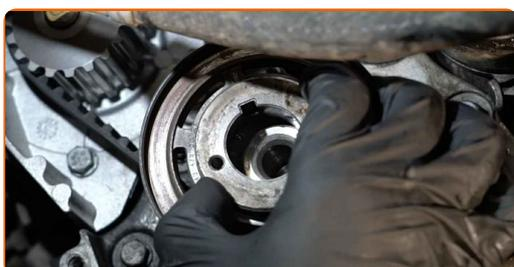
**83** Instale o parafuso de fixação.
