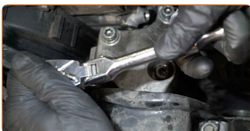
**19** Desaperte os fixadores de apoio do motor. Use Torx T50. Use uma chave de catraca.
