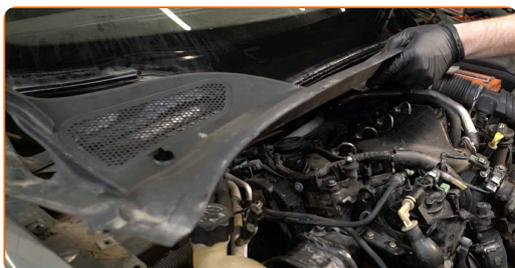
**120** Instale os fixadores da carenagem da grelha de plástico do limpa para-brisas.
