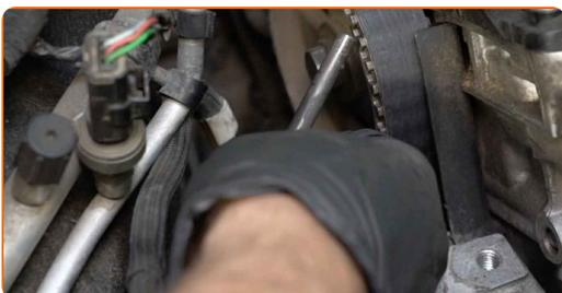
**86** Aparafuse o fixador da polia da cambota. Use uma chave soquete nº 22. Use uma chave de catraca.
