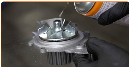
**67** Instale a junta da bomba de água.
