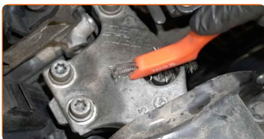
**18** Desaparafuse os fixadores, que ligam o suporte do motor à carroçaria. Use uma chave soquete nº E14. Use uma chave de catraca.
