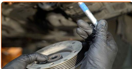
**99** Aperte o fixador da polia da cambota. Use uma chave soquete nº 22. Use uma chave de torque. Aperte-o para o torque de 80 Nm.+60°
