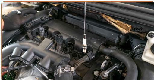
**8** Aplique uma camada fina de um lubrificante antigripante de alta temperatura específico às rosas das novas velas de ignição.
