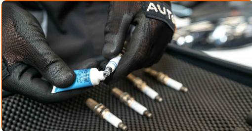
**9** Instale as velas de ignição novas nos seus locais de montagem.
