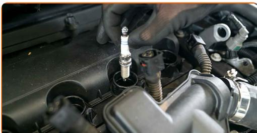
**10** Aparafuse as novas velas de ignição e aperte-as. Use a chave de velas de ignição de 12 pontos #14. Use uma chave de torque. Aperte-o para o torque de 23 Nm.
