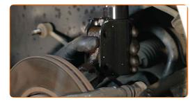
52 Instale os parafusos de fixação.
