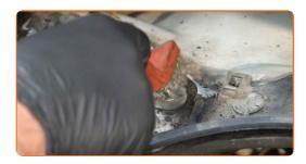
Solte o fixador superior do apoio da coluna de suspensão. Use uma chave soquete nº 13. Use uma chave de catraca.
