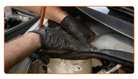
Aparafuse os fixadores da tampa do suporte da suspensão. Use uma chave soquete nº 10. Use uma chave de catraca.
