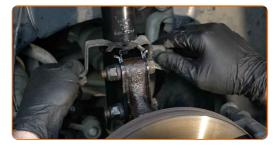
Aperte o suporte de fixação da mangueira do travão do amortecedor. Use uma chave soquete nº 10. Use uma 56 chave de catraca.
