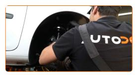
Aparafuse a fixação superior de montagem do suporte do amortecedor. Não o aperte.
