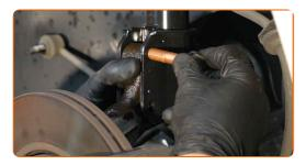
Aparafuse o fixador que conecta o amortecedor à manga de eixo. Use uma chave combinada nº 18. Use uma chave soquete nº 18. Use uma chave de catraca.
