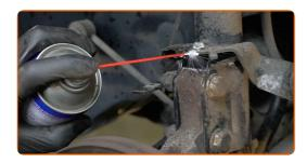
Desaperte o suporte de fixação da mangueira do travão do amortecedor. Use uma chave soquete nº 10. Use uma chave de catraca.
