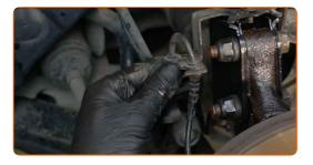
Instale o terminal do estabilizador transversal.
