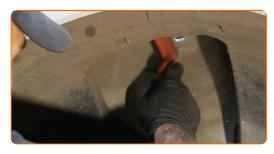
Instale o amortecedor no arco da roda.
