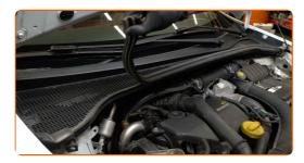
Remova os clipes da grelha da capota. Use uma ferramenta de remoção de clipe.
