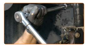
Aperte os fixadores inferiores que conectam a coluna de suspensão à manga de eixo. Use uma chave combinada nº 18. Use uma chave soquete nº 18. Use uma chave de torque. Aperte-o para o torque de 105 Nm.
