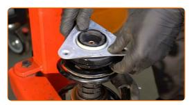
Aperte a porca do suporte do amortecedor da haste do pistão. Use uma chave soquete nº 18. Use HEX n.º H6. Use uma chave de torque. Aperte-o para o torque de 62 Nm.
