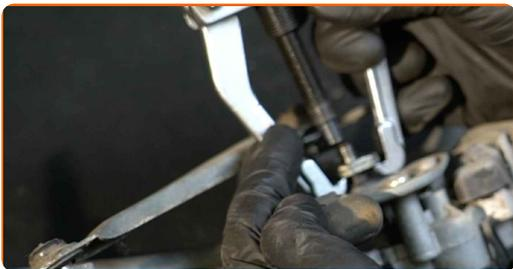
**18** Limpe os fixadores do motor do limpapa-brisas. Use uma escova metálica. Use spray WD-40.
