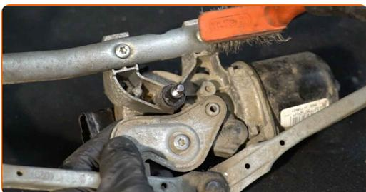
**19** Desaparafuse os fixadores do motor do limpapa-brisas. Use Torx T30. Use uma chave de catraca.
