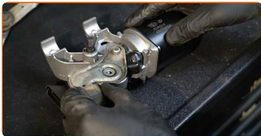
**22** Aparafuse os fixadores do motor do limpa-para-brisas. Use Torx T30. Use uma chave de catraca.
