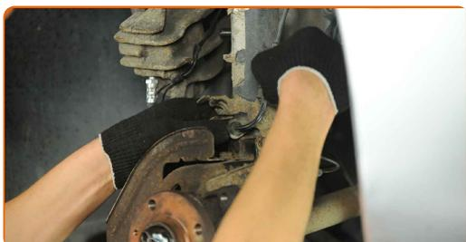
**67** Limpe o cubo. Use uma escova metálica. Trate a superfície de contacto. Use massa de cobre.
