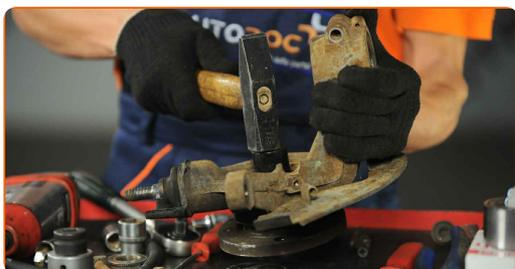
**38** Remova o anel de retenção do mancal do cubo de roda. Use alicates de ponta arredondada.
