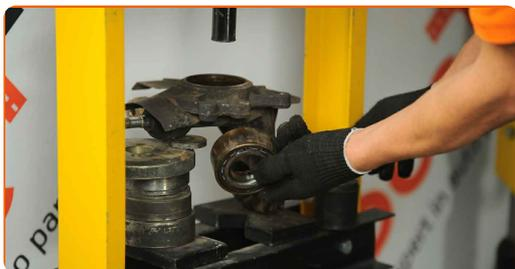
**40** Limpe o local de montagem do rolamento de cubo. Use uma escova metálica. Use spray WD-40.
