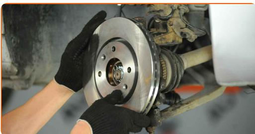
**69** Aperte os parafusos do disco de travão. Use a chave Phillips. Use uma chave de torque. Aperte-o para o torque de 10 Nm.
