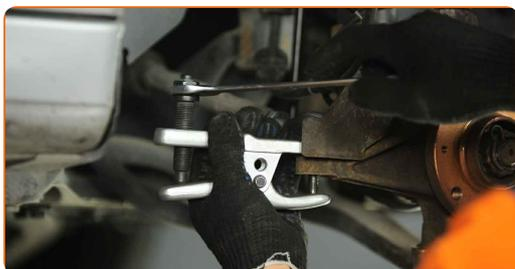
**22** Limpe o fixador que liga o braço de suspensão à junta esférica. Use uma escova metálica. Use spray WD-40.
