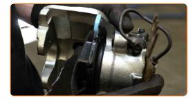
Instale a pinça do travão e fixe-o. Use HEX n.º H7. Use uma chave de torque. Aperte-o para o torque de 30 Nm.
