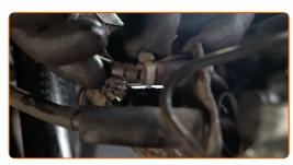
Conecte o sensor do indicador de desgaste das pastilhas de travão.
