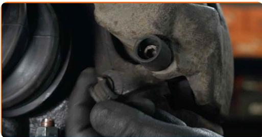
**9** Desaparafuse os fixadores da pinça de travão. Use HEX n.º H7. Use uma chave de catraca.
