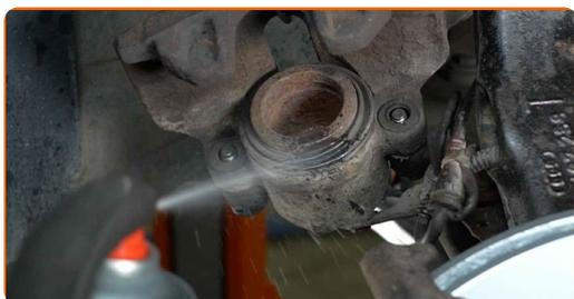
**Substituição: pastilhas de travão – Audi A6 C5 Avant. Conselho da AUTODOC:**
