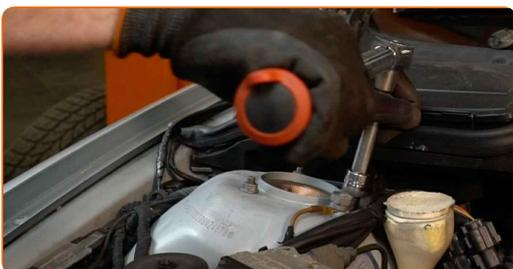
**96** Trate os fixadores do apoio da coluna de suspensão. Use massa de cobre.
