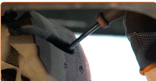
**14** Desaperte a fixação da braçadeira da pinça. Use uma chave soquete nº 18. Use uma chave de tarraxa.
