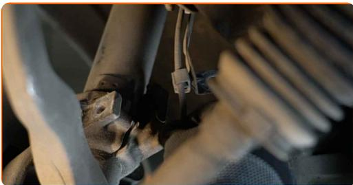
**26** Limpe todas as juntas do braço. Use uma escova metálica. Use spray WD-40.
