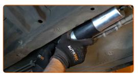
Aparafuse o suporte de montagem do filtro de combustível. Use HEX n.º H5. Use uma chave de catraca.
