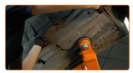
Aparafuse os fixadores da parte inferior do painel de cobertura da carroçaria. Use uma chave soquete nº 8. Use uma chave soquete nº 10. Use uma chave de catraca.
