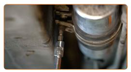
Aparafuse o elemento de fixação que liga a linha de combustível ao alojamento do filtro de combustível. Use uma chave soquete nº 5.5. Use uma chave de catraca.
