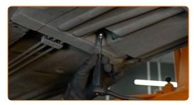
Retire os clipes da parte inferior do painel de cobertura da carroçaria. Use uma ferramenta de remoção de clipe.
