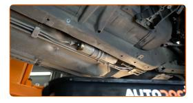
Desaparafuse o fixador que conecta a linha de combustível ao alojamento do filtro de combustível. Use uma chave soquete nº 5.5. Use uma chave de catraca.
