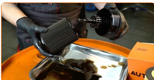
**13** Remova o anel O-ring de vedação da tampa do filtro de óleo. Use uma chave de fenda plana.
