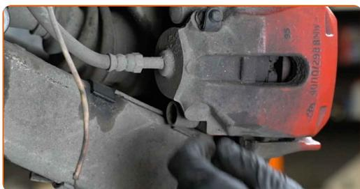
**16** Desparafuse a fixação de pinça de travão. Use HEX n.º H7. Use uma chave de catraca.
