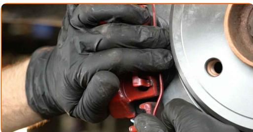
**30** Trate a superfície onde o disco de travão entra em contacto com o aro da roda. Use massa de cobre.
