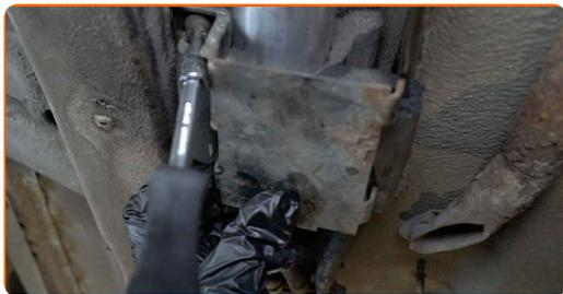
**21** Aparafuse o fixador do suporte da bomba de combustível. Use HEX n.º H5. Use uma chave de catraca.
