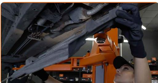
**5** Desaparafuse o fixador do suporte da bomba de combustível. Use HEX n.º H5. Use uma chave de catraca.
