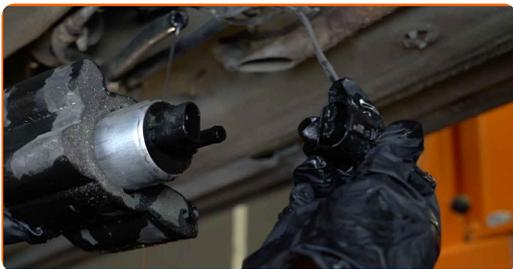
**11** Remova a bomba de combustível juntamente com o seu suporte.
