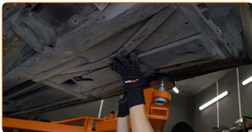
**23** Aparafuse os fixadores da cobertura de plástico da carroçaria do veículo. Use uma chave soquete n.º 8. Use uma chave soquete n.º 10. Use a chave Phillips. Use uma chave de catraca.
